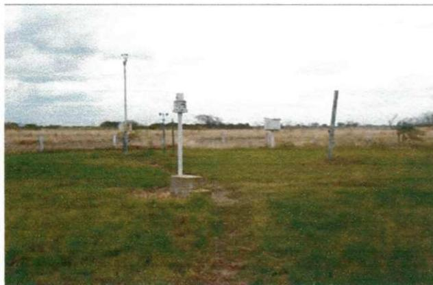
Figura 9a. Estação Agrometeorológica Convencional - Campo Experimental de Mandacarú - Embrapa Semiárido, Juazeiro/BA. Fotos: Magna Selma Beserra de Moura
