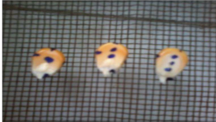
Figura 3.10 – Grãos de milho no cesto de tela fina de alumínio para encolhimento.
