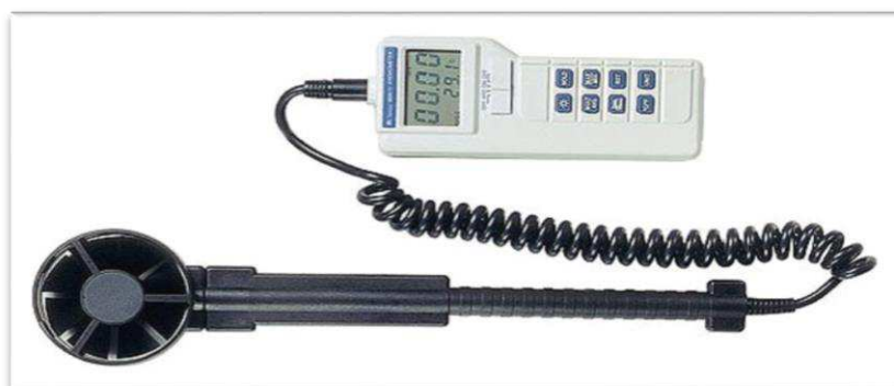
Figura 3.13 – Anemômetro de palheta utilizado para medir a velocidade do ar quente.
