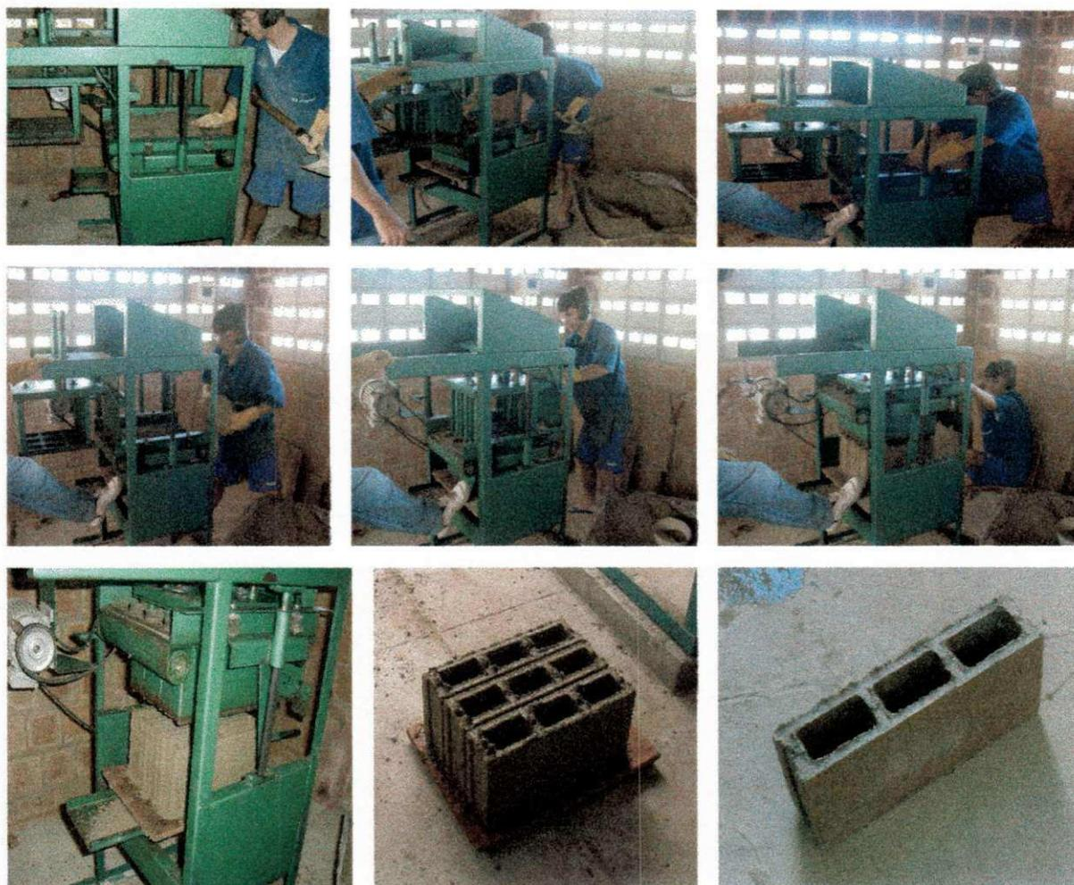
Figura 3.6 – Detalhe do Processo de Moldagem dos Blocos.
