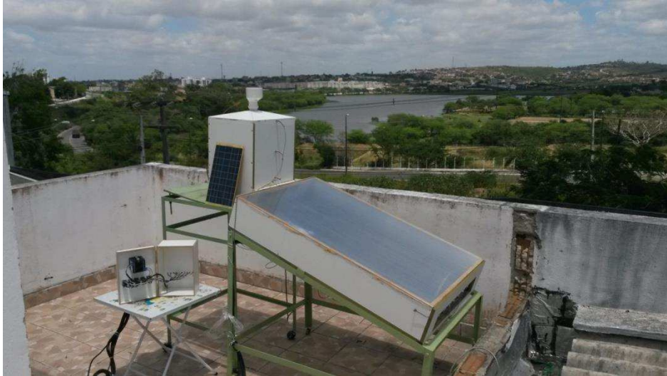
Figura 3.4. Secador solar de irradiação indireta.
