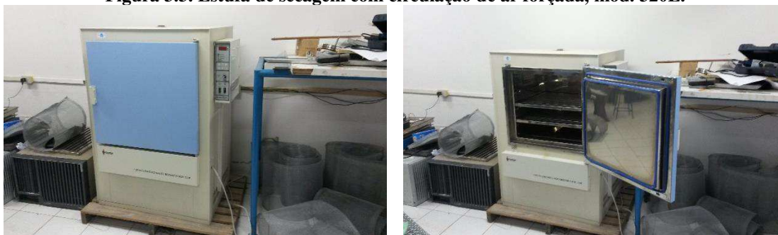
Figura 3.3. Estufa de secagem com circulação de ar forçada, mod. 320E.
