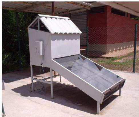
Figura 2.8. Secador híbrido solar-elétrico com controle de temperatura do ar de secagem.
