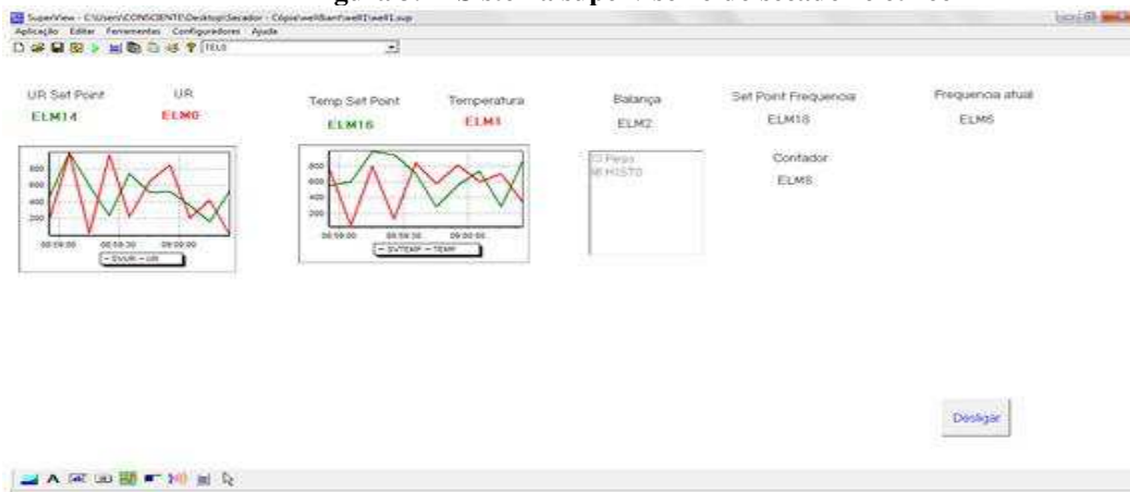
Figura 3.27 Sistema supervisorio do secador elétrico
