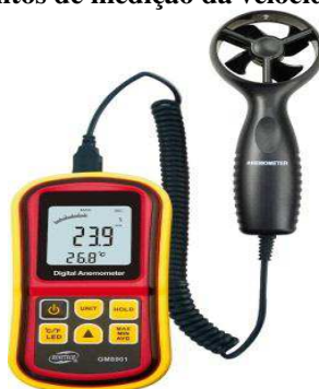
Figura 3.42. Equipamentos de medição da velocidade do ar (Anemômetro).
