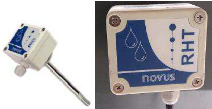
Figura 3.26 Sensor de umidade e temperatura do secador elétrico.
