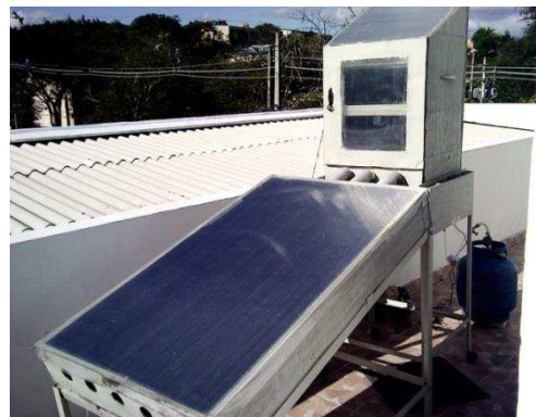
Figura 2.9. Secador híbrido solar-gás com sistema de aquecimento auxiliar do ar de secagem.
