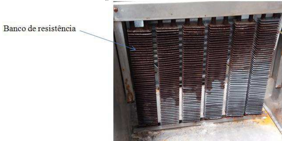
Figura 3.22. Banco de resistência do secador elétrico.
