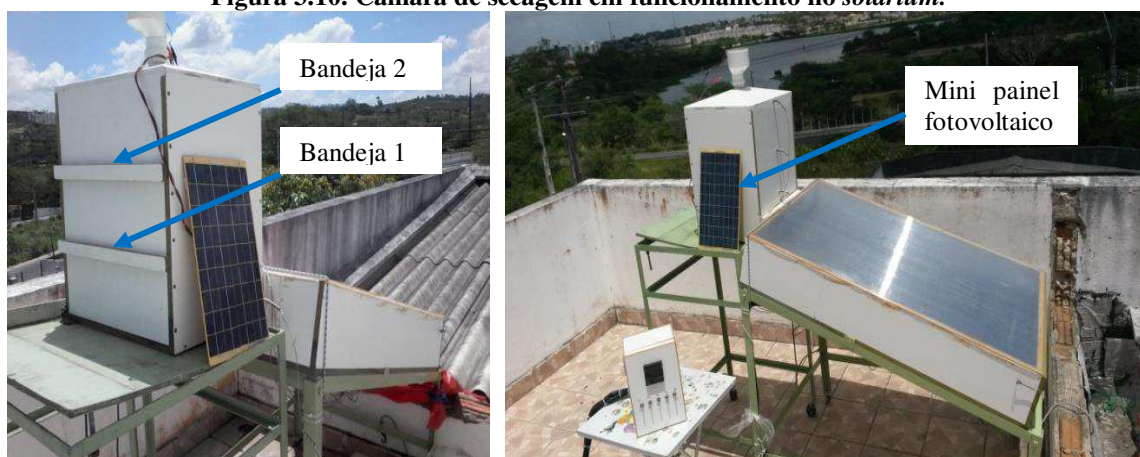
Figura 3.10. Câmara de secagem em funcionamento no solarium.
