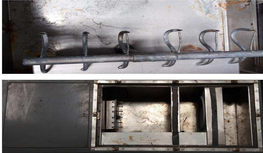
Figura 3.28 Sistema de umidificação do ar de secagem do secador elétrico
