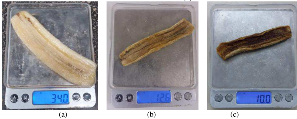
Figura 3.43. Balança digital modelo KC 01, marca Western: banana in natura (a), banana passa (b) e massa seca da banana (c)
