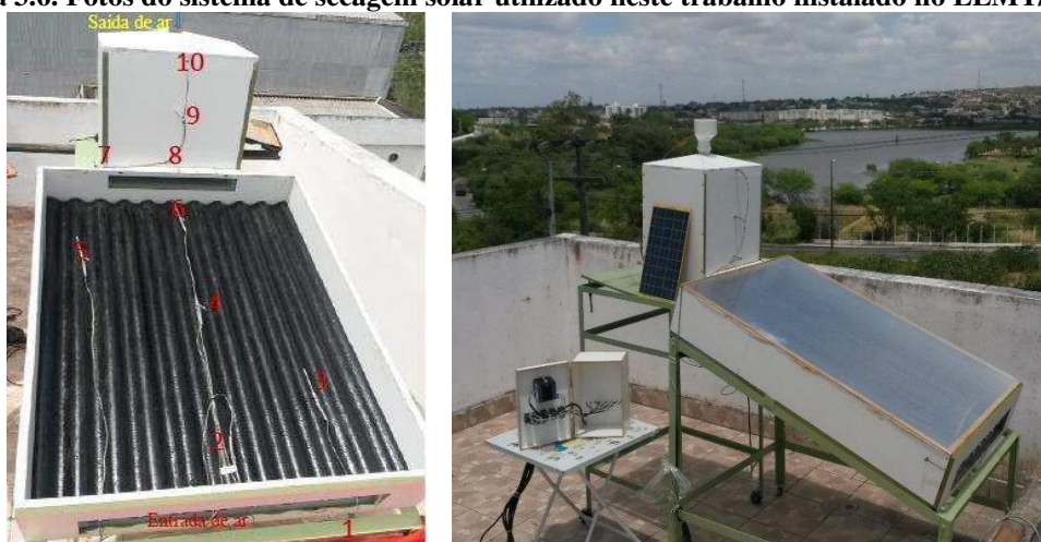
Figura 3.6. Fotos do sistema de secagem solar utilizado neste trabalho instalado no LEMT/UFCG.
