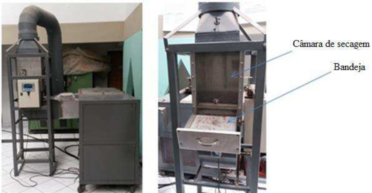
Figura 3.20 Secador elétrico com sistema de aquisição e supervisor integrado.
