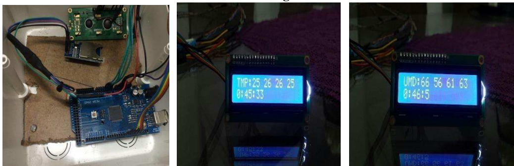
Figura 3.19. Sistema de aquisição de dados (Arduino), usado para medir umidade relativa e temperatura do ar de secagem.
