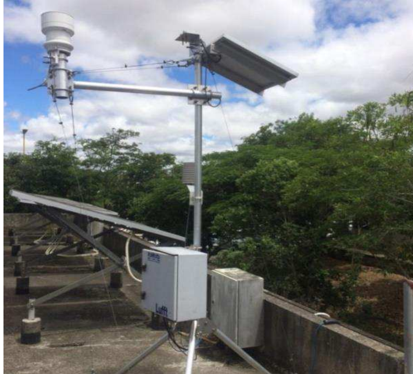
Figura 3.35. Estação meteorológica modelo HD32MT.1, SN 11031486 e FW 0714141114.
