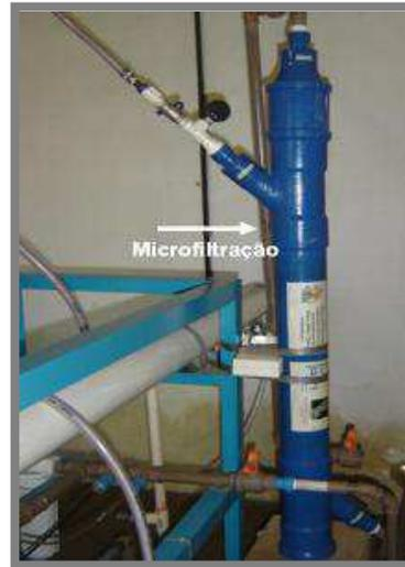
Figura 13 - Módulo de membranas de microfiltração
