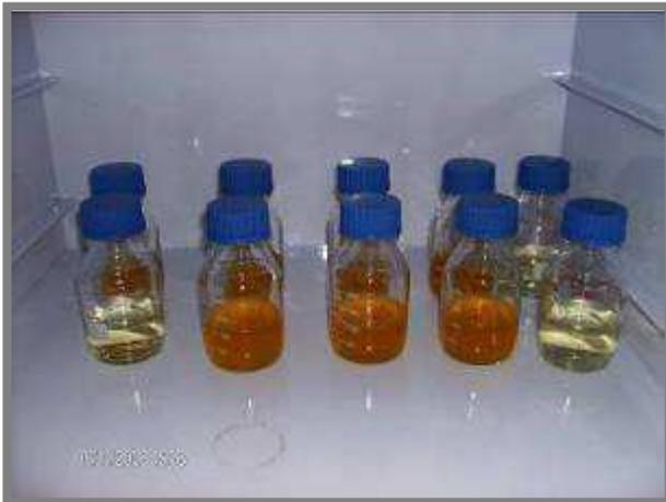
Figura 21 – resultados do método cromofluorogênico com ausência e presença de coliformes totais
