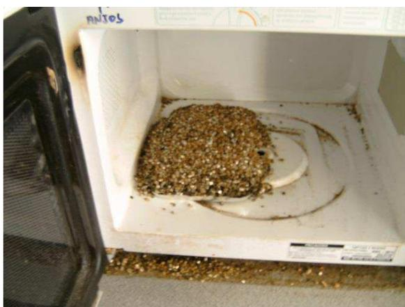
Figura 5.4- Amostra de vermiculita bruta da figura 5.2 após expansão.
