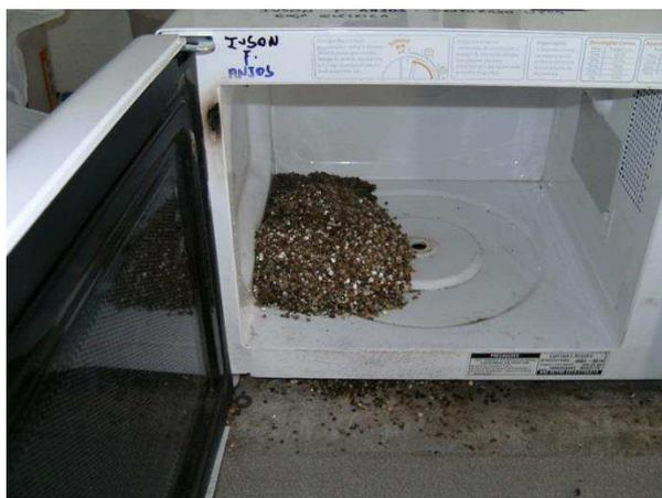
Figura 5.5- Amostra de vermiculita bruta da figura 5.3 após expansão.
