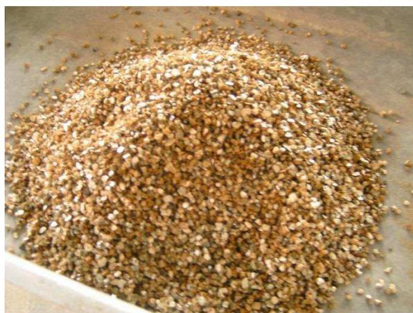
Figura 6.1- Vermiculita expandida por micro-ondas
