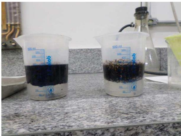
Figura 6.5- Óleo em fase de adsorção pela vermiculita expandida.
