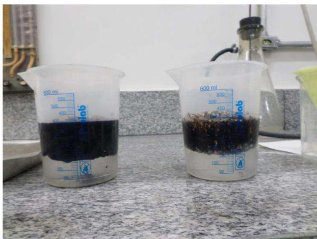
Figura 6.4- Vermiculita expandida em fase de adsorção do óleo. À esquerda vermiculita expandida comercial, à direita vermiculita expandida por MW.
