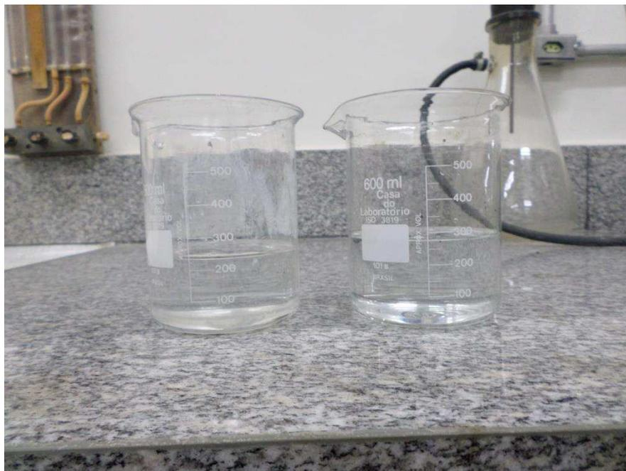
Figura 6.7- Água após adsorção do óleo pela vermiculita expandida. À esquerda adsorção por vermiculita expandida comercial. À direita adsorção pela vermiculita expandida por MW.
