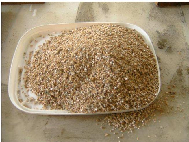
Figura 6.2- Vermiculita expandida comercial.
