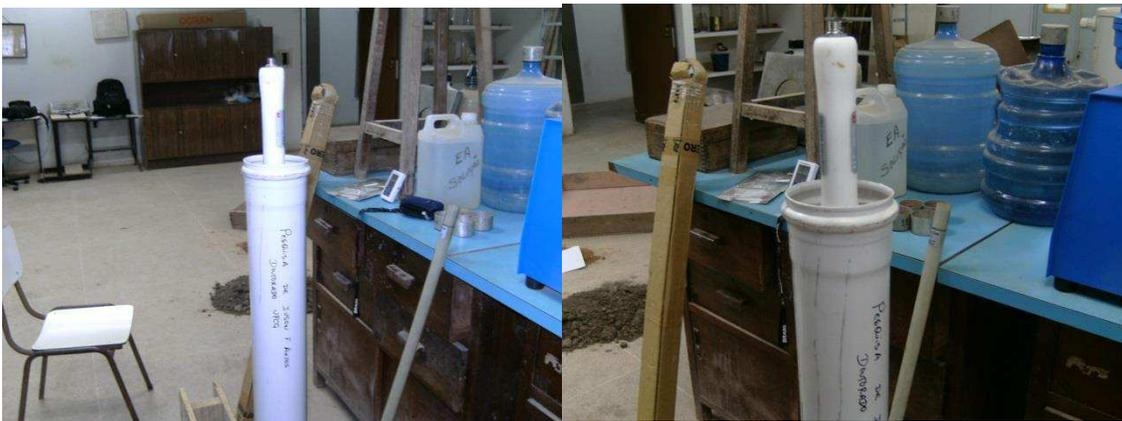
Figura 4.5- Sonda PR2 inserida no tubo de acesso.
