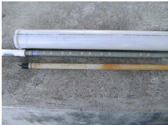
Figura 4.2- Sonda PR2- De cima para baixo: a) tubo de PVC utilizado nos ensaios, b) sonda PR2 e c) tubo de acesso.
