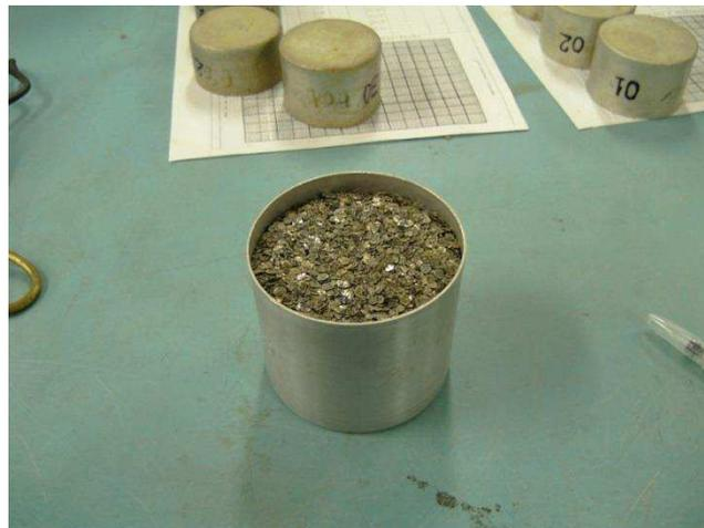
Figura 4.11- Diminuição do volume devido à perda de umidade após 24 horas a 110 °C..
