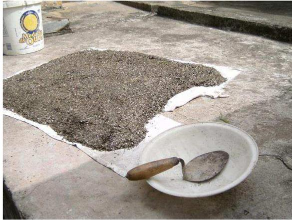
Figura 4.7- Vermiculita durante a secagem ao Sol.
