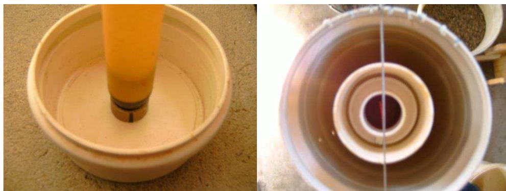
Figura 4.6-Dispositivo desenvolvido para centralização do tubo de acesso.
