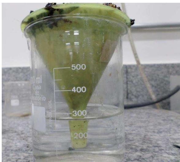
Figura 6.6- Etapa de filtragem para recuperação da água (vermiculita expandida por MW).
