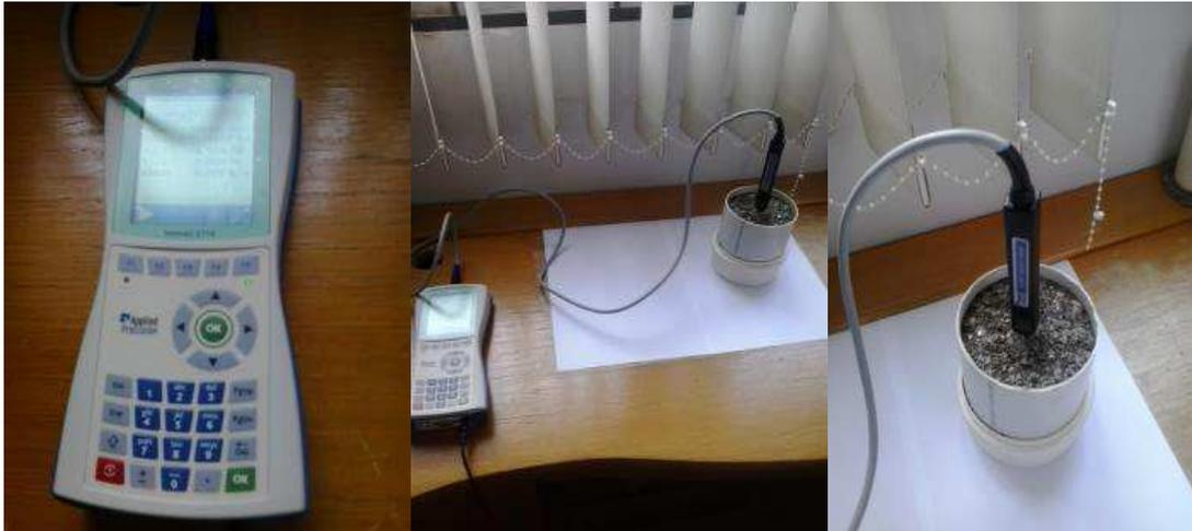
Procedimento para determinação da condutividade térmica e difusidade da vermiculita.
