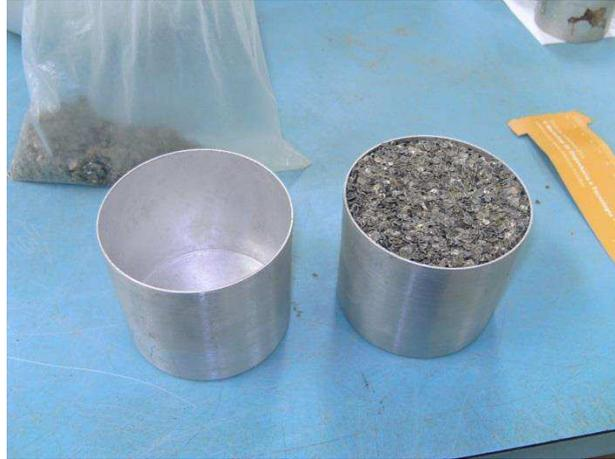
Figura 4.10- Amostra de vermiculita antes de ser submetida a 110 °C por 24 horas.
