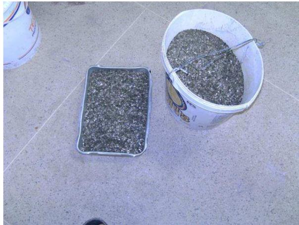
Figura 4.8 – Amostra de vermiculita após secagem ao Sol por 8 horas
