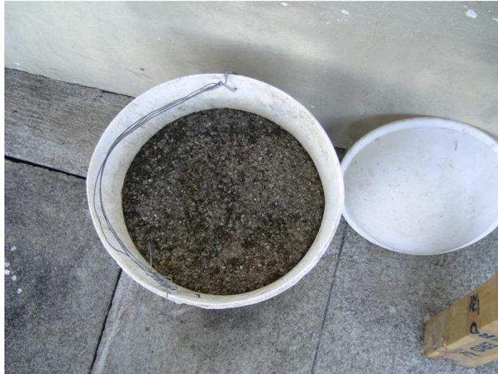
Figura 4.4- Amostra de vermiculita utilizada nos ensaios.
