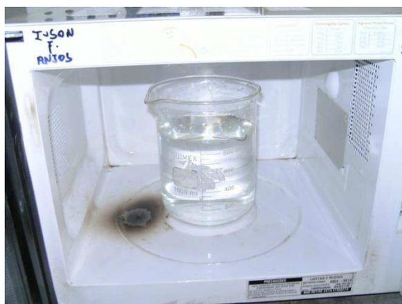
Figura 5.6- Procedimento para a determinação da potência real do forno de micro-ondas.
