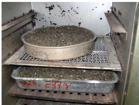
Figura 4.9 – Amostra de vermiculita em estufa mufla a 110 °C por 24 horas
