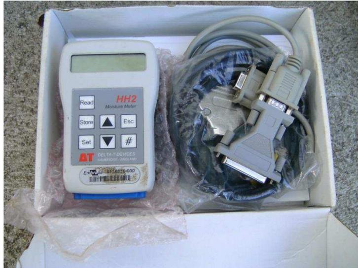
Figura 4.3– Medidor de umidade HH2. É responsável pela leitura e processamento dos dados obtidos pela sonda PR2.
