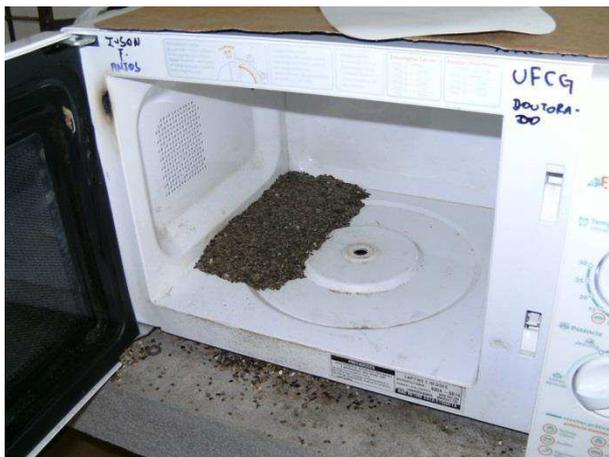
Figura 5.3- Amostra bruta de vermiculita no interior do forno
