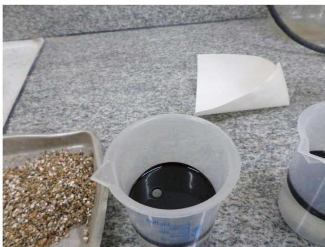
Figura 6.3- Recipiente utilizado para simular uma contaminação por óleo.
