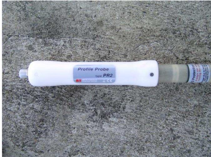
Figura 4.1- Sonda PR2- Parte do oscilador e conector de transferência dos dados.
