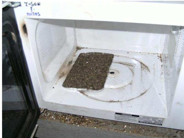
Figura 5.2- Posicionamento da amostra de vermiculita bruta no interior da cavidade do forno de MW.
