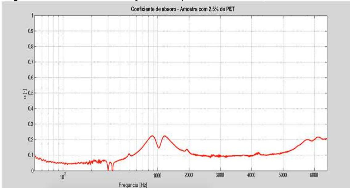
De acordo com os resultados ilustrados na Figura 57, observa-se que a amostra do concreto com 2,5% de PET triturado, apresentou picos de 0,23 nas frequências de 900Hz e de 1200Hz. Entre 2kHz e 5kHz o coeficiente se mostrou aproximadamente linear, com valor de aproximadamente 0,1. Entre 5kHz e 6kHz há um aumento exponencial, quando os valores do coeficiente de absorção chegam a 0,2. Entre 7kHz e 12kHz o coeficiente se mantém abaixo de 0,1.
