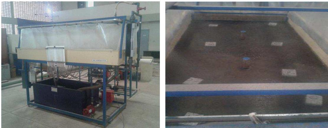
A variação de massa, calculada segundo a Equação 12, foi utilizada como parâmetro para avaliar a resistência à erosão causada pela chuva, sendo os resultados comparados aos encontrados para as placas de referência.
