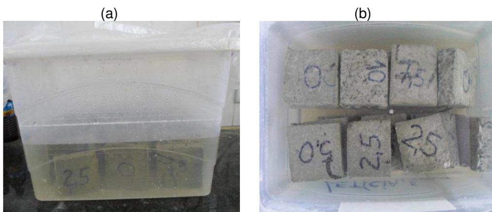
Para realização deste ensaio, foram tomados como amostras, blocos após serem submetidos ao ensaio para determinação da resistência a compressão simples. Estes foram serrados para obtenção de placas com as
