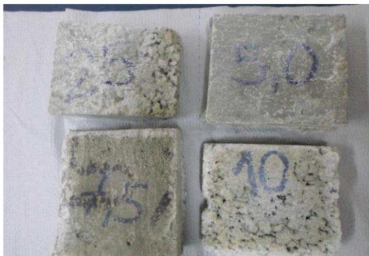
Verifica-se que ao final do ensaio, as placas de concreto apresentaram pequena deterioração localizada nas arestas formadas pela face lateral e na superfície (Fig. 54), devido à intrusão dos sulfatos em duas faces adjacentes.
