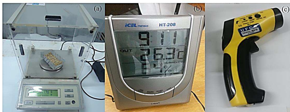
Figura 3.4. Instrumentos de medição: (a) Balança de precisão digital; (b) Termo-higrômetro digital; e (c) Termômetro tipo pistola infravermelho digital
