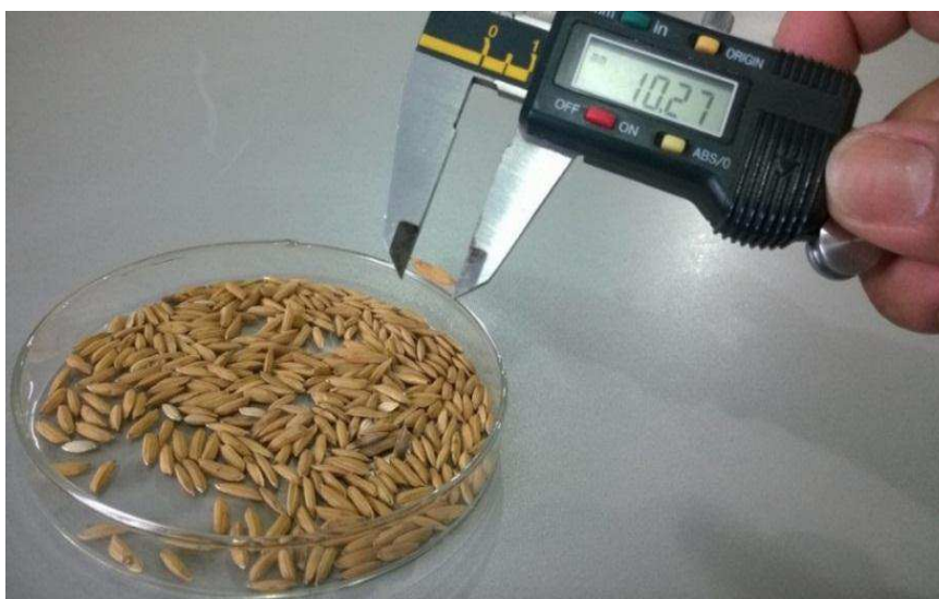
Figura 3.2 – Medições das dimensões (comprimento, largura e espessura) dos grãos.
