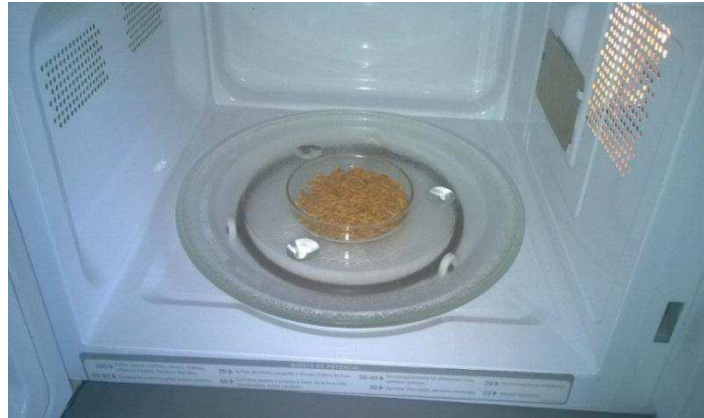
Figura 3.6 - Amostra posicionada no forno de micro-ondas para início da secagem.
