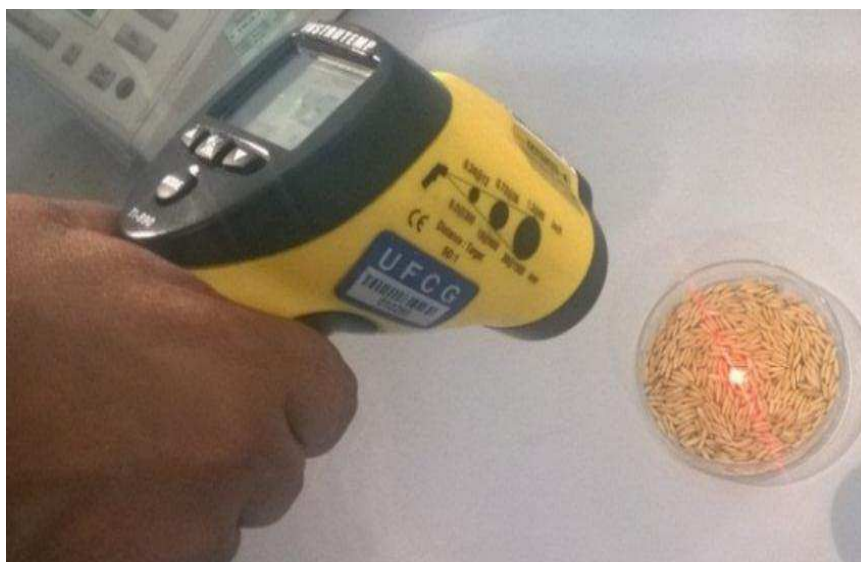
Figura 3.5 - Medição da temperatura inicial da amostra.
