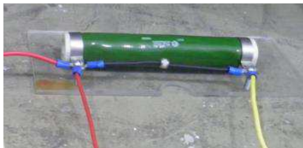
Figura 32. Resistor shunt com gap de proteção.
