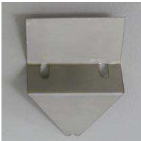
Figura 34. Eletrodo de alta tensão.
