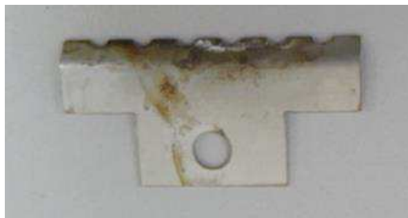
Figura 37. Eletrodo de terra degradado a 3,5 kV.
