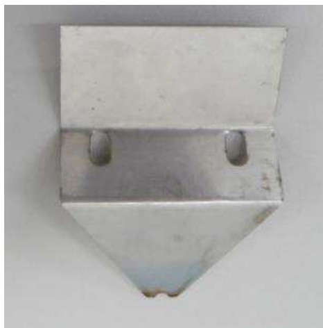
Figura 36. Eletrodo de alta tensão degradado a 3,5 kV.
