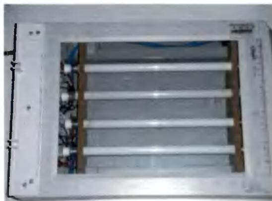
**Figura 3.13** – Unidade de base com quatro fluorescentes de 30 cm de 8 Watts, 6400 K e reator eletrônico
