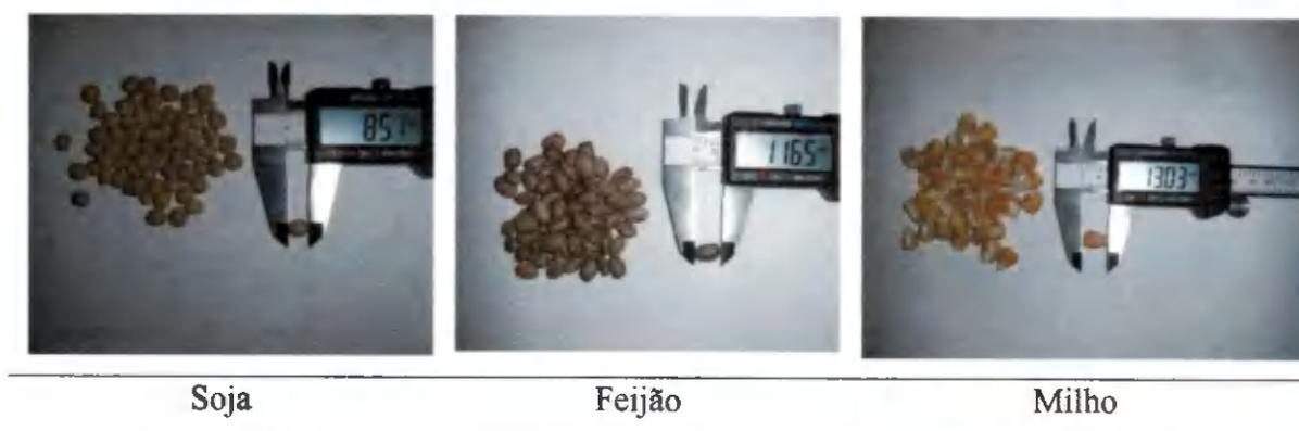
**Figura 3.4** - Determinação do comprimento, largura e espessura das sementes de soja, feijão e milho, com auxílio de paquímetro
