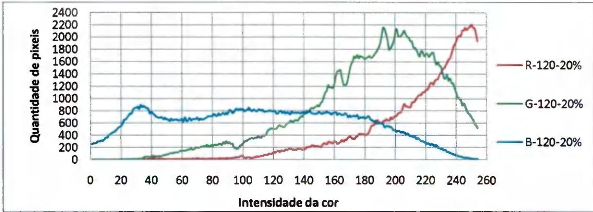
**Figura 4.92** – Histograma de cores de amostra de milho armazenado aos 120 dias, com 20% de teor de água
