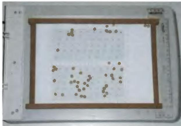
**Figura 3.15** – Unidade de negatoscópio com amostra na bandeja de ensaio
