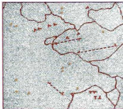
Figura 2.5: Imperfeições superficiais. Os contornos de grãos são indicados por linhas, deslocações por  $\perp$ , deslocações estendidas por  $\perp$ ----- $\perp$  e lacunas por um quadrado. Fonte: Referência[55].
