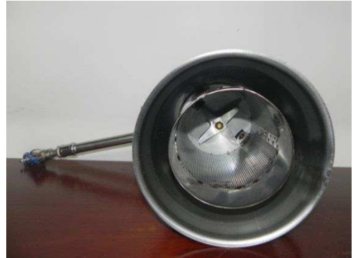
Figura 19 - Cilindro microperfurado com lâminas
