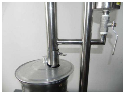
Figura 21 - Pino de acoplamento na base do copo
