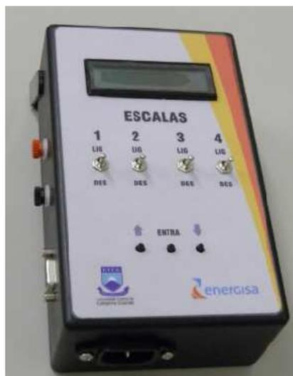
**Figura 3.9** – Fotografia do medidor de potenciais de superfície.
