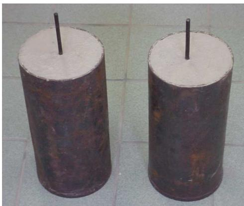
**Figura 3.3** – Massas metálicas utilizadas nas medições de potencial de toque.
