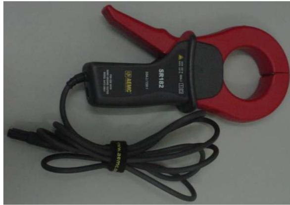
**Figura 3.7** – Pinça amperimétrica da AEMC Instruments<sup>®</sup> utilizada nas medições de resistência de malha de aterramento em instalações energizadas.
