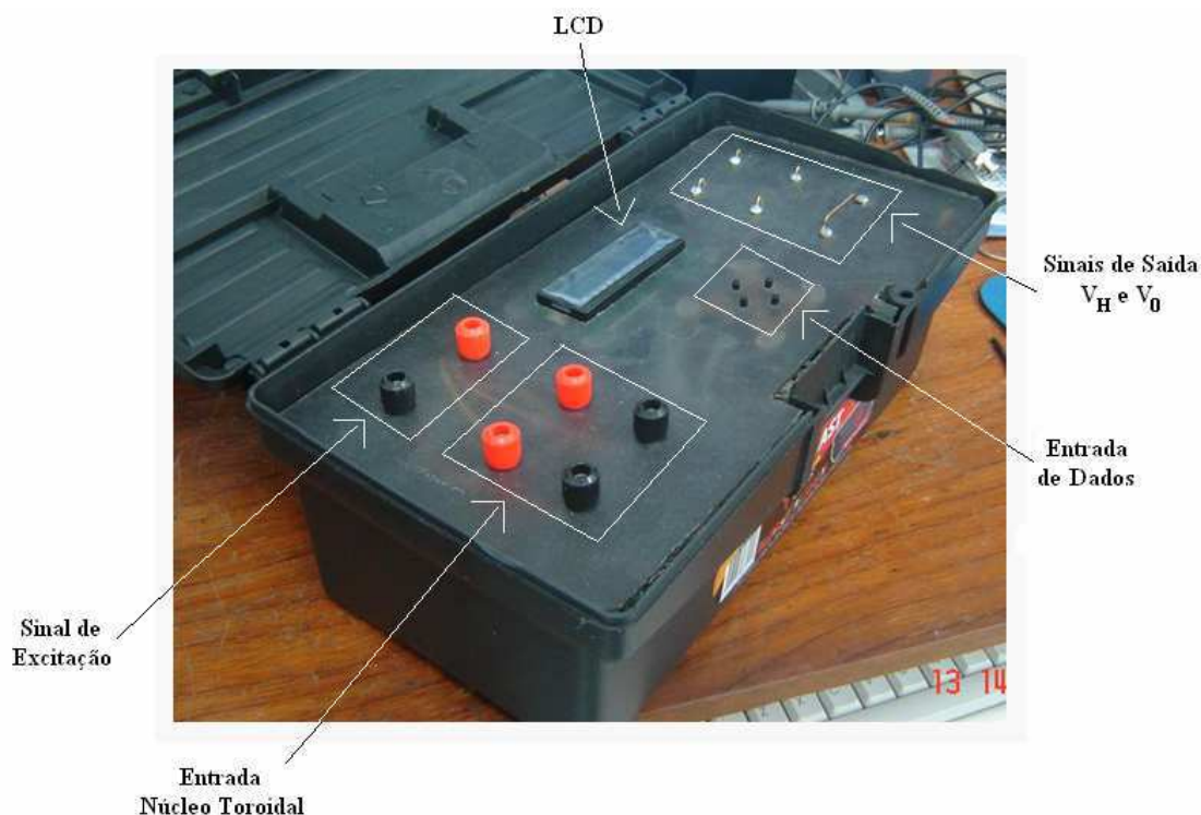
Figura 4.4 - Equipamento para caracterização magnética de núcleos toroidais magneticamente moles.
