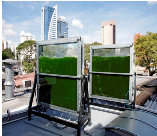
Figura 2.3- Fotobiorreator de placas. Fonte: NOVUS (2013)
