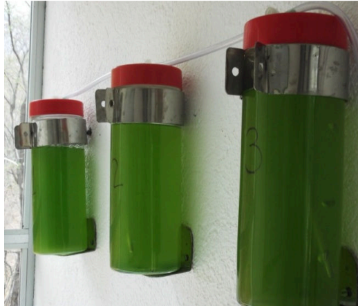
Figura 3.2 - Cultivo de Chlorella sp. em fotobiorreator de bancada
