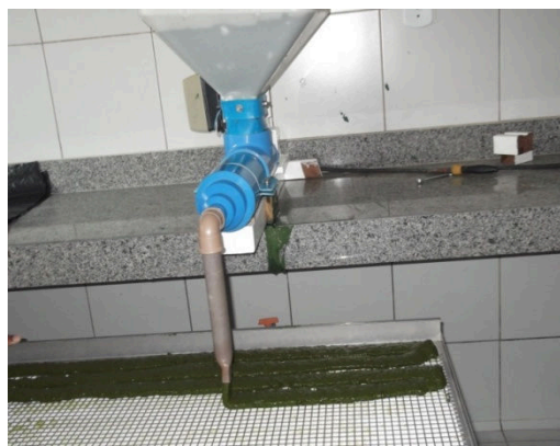
Figura 3.6 – Extrusora distribuindo a biomassa fresca de Chlorella nas bandejas
