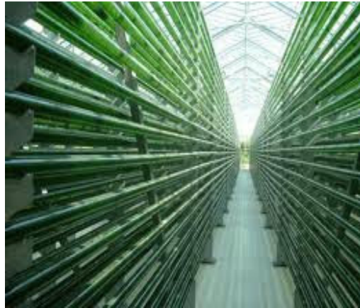
Figura 2.2- Biorreator tubular Fonte: PULZ e GROSS (2004)
