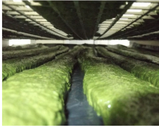
Figura 3.7 - Secagem da biomassa de Chlorella sp. em estufa
