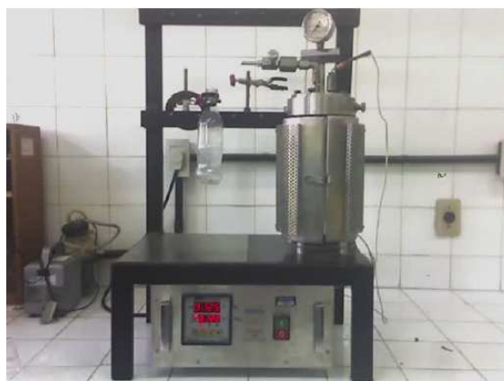
Figura 12: Reator de aço inoxidável utilizado na hidrólise ácida
