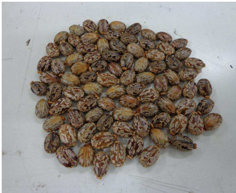
Figura 4.22 – Sementes de mamona da variedade BRS Energia, após o processo de secagem, à temperatura do ar de 40°C.
