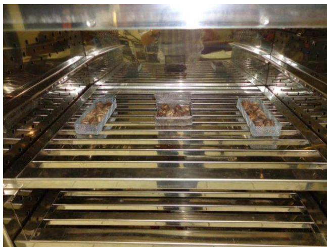
Figura 3.9 - Vista interna da estufa de secagem com amostras de frutos de mamona da cultivar BRS Energia.
