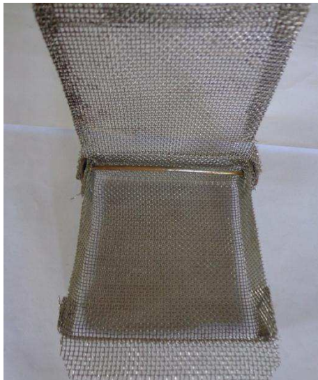
Figura 3.5 - Bandeja de tela de arame com tampa utilizada nos experimentos.
