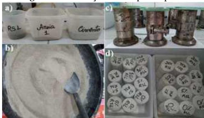
Legenda: a) Aglomerantes e RSL pesados; b) Mistura; C) Moldagem dos CP; d) CP desmoldados e em tempo de cura.
