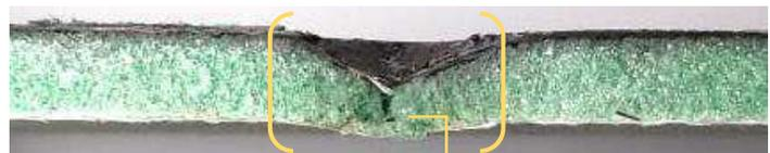
Fratura das fibras, esmagamento e rasgo da espuma
