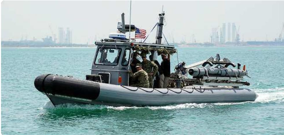
Figura 2.9 – AUV Hydroid REMUS 600 em operação junto à Marinha dos Estados Unidos.
