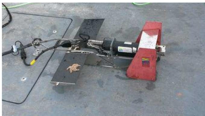
Figura 2.3 – Submarino não-tripulado rebocado Osil MiniBAT FC60. Fonte: Osil (2018).
