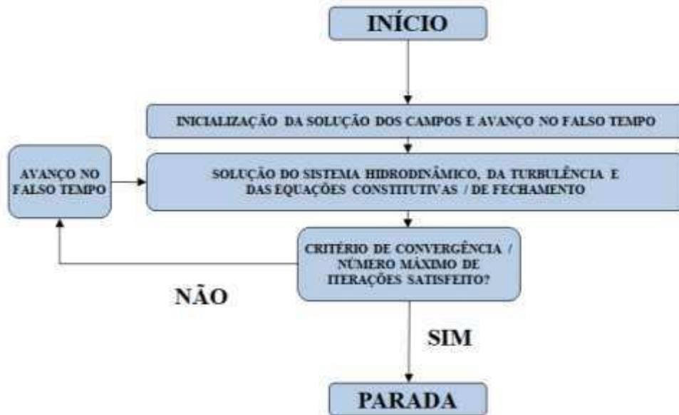
Figura 3.18 – Fluxograma representando o processo simplificado de solução utilizado pelo *CFX-Solver* para o problema do escoamento ao redor do AUV estudado. Fonte: Adaptado de Ansys (2014).
