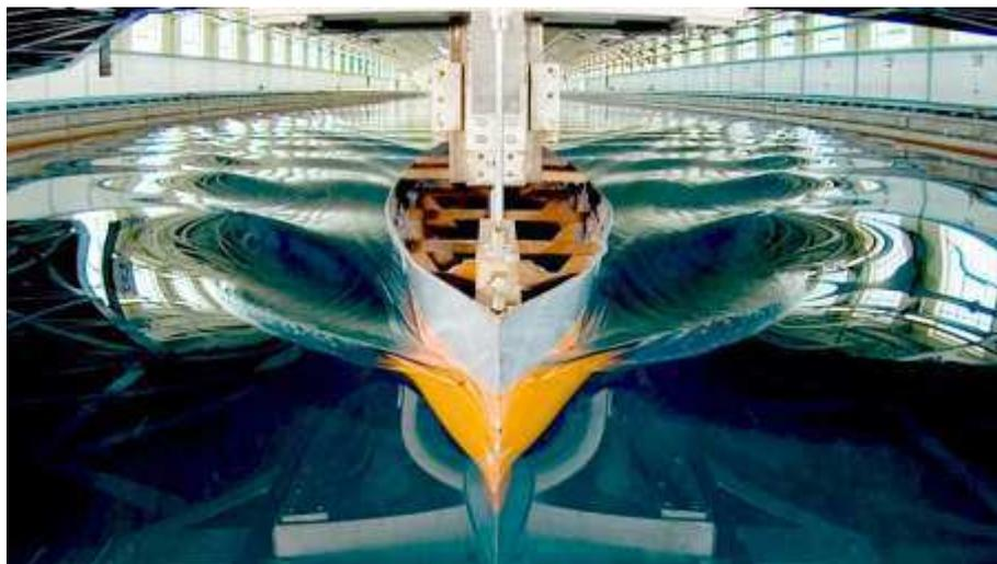
Figura 2.11 – Modelo de casco de navio sendo testado em tanque de água. Fonte: Bluebird Marine Systems (2019).
