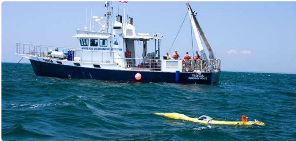
Figura 2.7 – AUV Hydroid REMUS 600 em operação oceanográfica. Fonte: Hydroid (2018).
