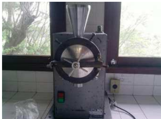
Figura 6: Moinho de Facas utilizado para trituração do sorgo sacarino
