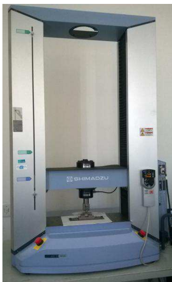
Figura 8: Equipamento AUTOGRAF AG-X 50KN da SHIMADZU para realização do ensaio de flexão
