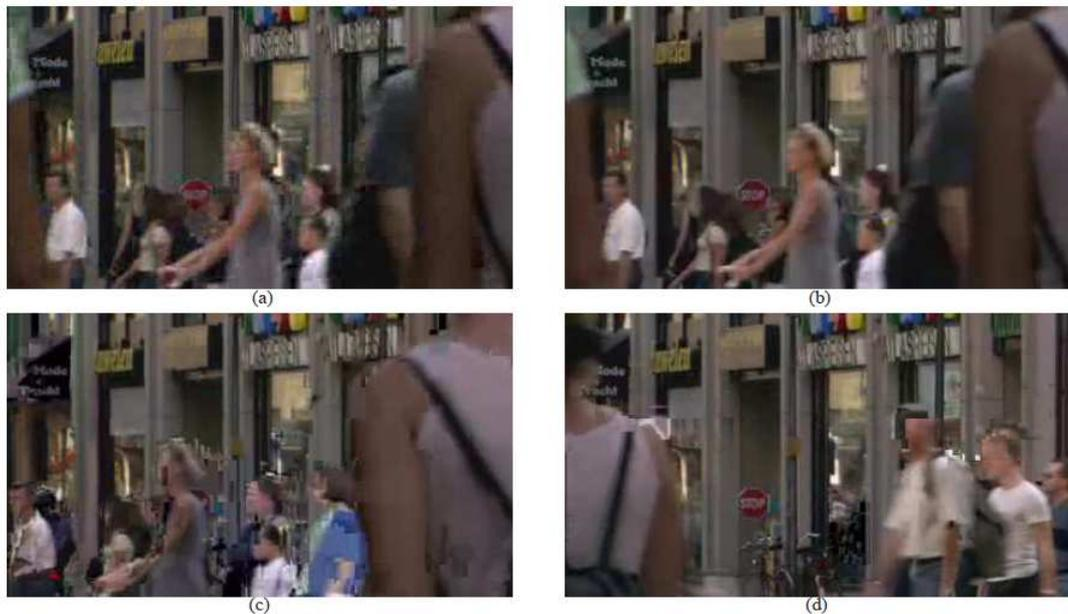
Figura A.3: Representação das degradações em um Quadro para a base de dados LIVE. (a) Quadro comprimido com MPEG-2 (b) Quadro comprimido com H.264 (c) Quadro gerado a partir da simulação de uma rede IP (d) Quadro gerado a partir da simulação de uma rede sem fio (Seshadrinathan *et al.*, 2010a).
