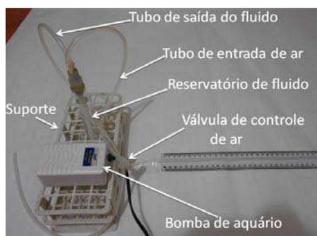
Figura 6.13: Montagem experimental para a bomba de vácuo
