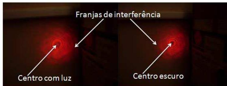
Figura 7.14: Franjas de interferência obtidas para o buzzer usando a montagem da Figura 7.13
