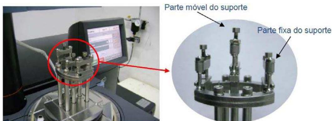
Figura 4.6: Equipamento de análise dinâmico-mecânica: à esquerda, é mostrado o suporte do tipo *Cantilever* para fixação das amostras
