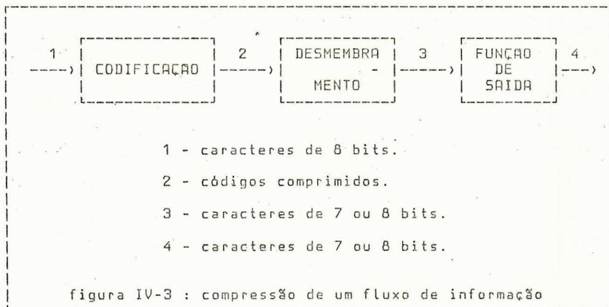
As caixas CODIFICAÇÃO e DESMEMBRAMENTO da figura IV-3, correspondem à função comprima.
