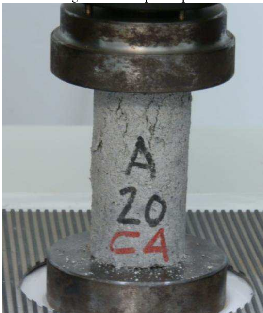
Figura 4.18a Ruptura tipo C
