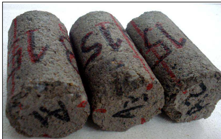
Figura 4.44 - Desgaste de corpos de prova devido à intrusão de sulfatos nas arestas
