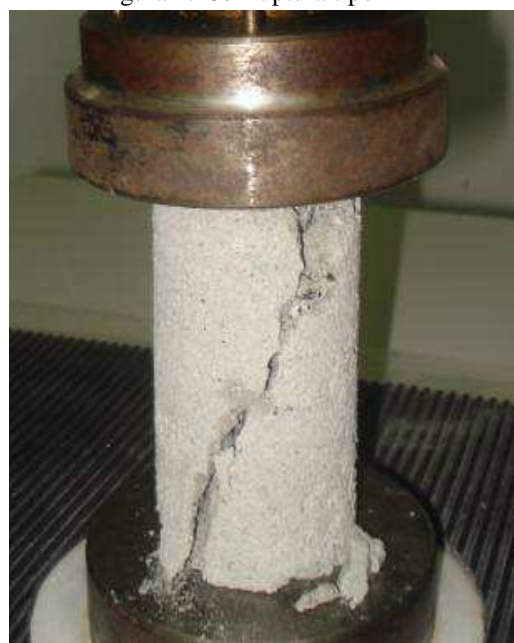
Figura 4.18b Ruptura tipo E
