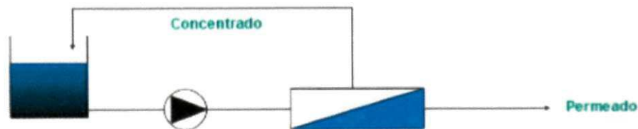
Figura 49 - Representação esquemática de um sistema de OR em processo de batelada
