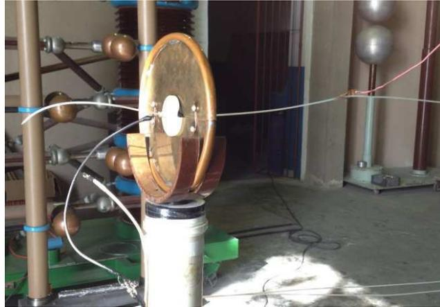
Figura 3.1: Amostra sendo ensaiada de fio sintético de monofilamento de poliamida.
