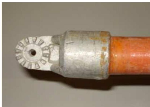
Figura 2.7: Detalhes da extremidade do Bastão Universal.
