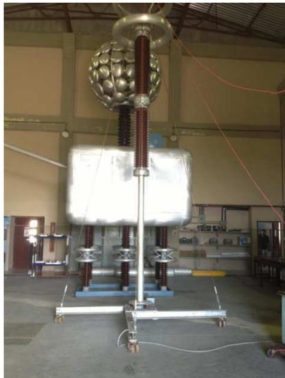
Figura 2.46: Divisor capacitivo do laboratório de alta tensão da UFCG.
