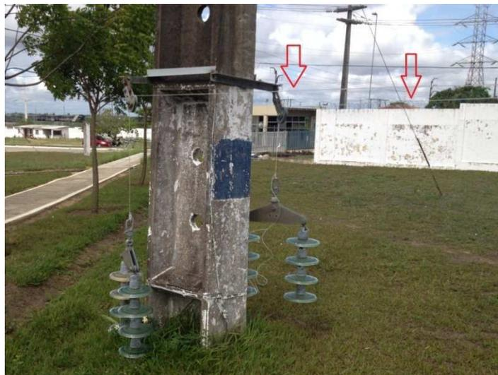
Figura 3.13: Envelhecimento 8 e 9 das amostra para terceiro ensaio.
