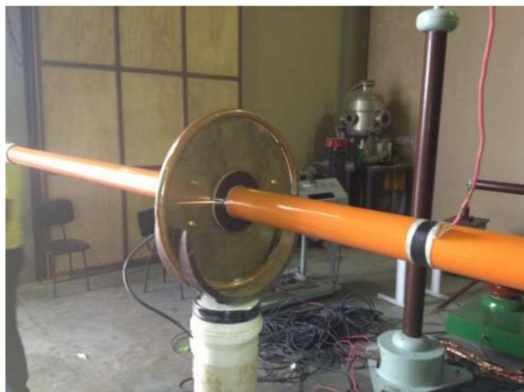
Figura 3.2: Amostra sendo ensaiada de batão isolante de 51 mm.
