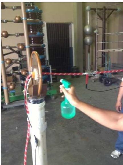
Figura 3.6: Amostra sendo ensaiada de corda (linha de vida) de 11 mm.
