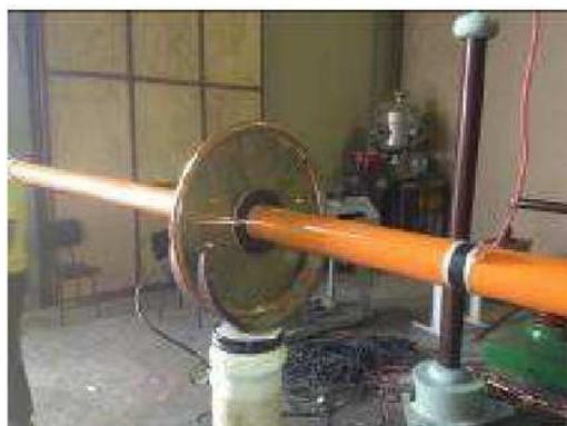
FIGURA 3 – ENSAIO EM BASTÃO ISOLANTE DE 51 mm LIMPO
