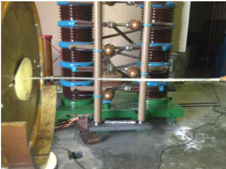
Figura 3.3: Amostra sendo ensaiada de bastonete isolante de 6 mm.
