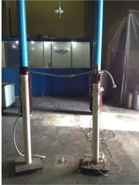
Figura 3.4: Amostra sendo ensaiada de corda (linha de mão) de seda de 5/8 de polegadas.
