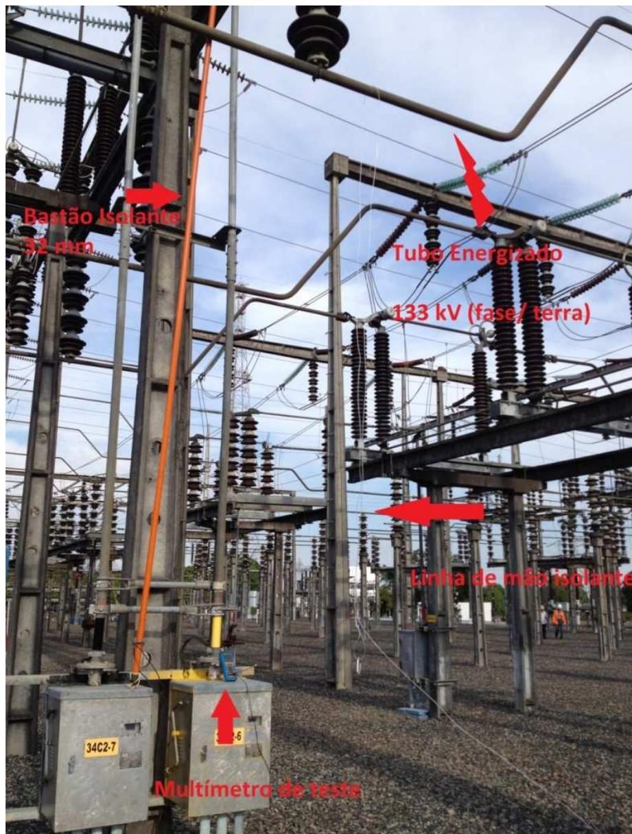
Figura 3.15: Medições de corrente de fuga no bastão isolante de 32 mm de diâmetro e na linha de mão isolante de 3 mm de diâmetro (monofilamento de poliamida).
