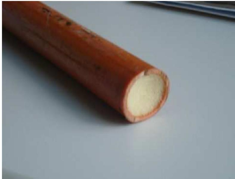
Figura 2.4: Detalhe do bastão isolante.
