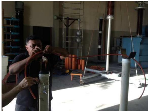
Figura 3.5: Amostra sendo ensaiada de corda (linha de mão) de aramida de 3/8 de polegadas.
