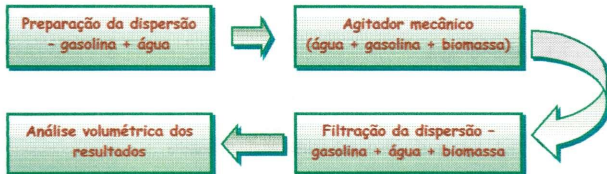
Figura 16. Fluxograma para a obtenção da capacidade de adsorção de cada biomassa.
