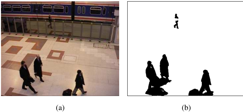
Figura 2.3: Exemplo de problema de segmentação causado por sombras. (a) Imagem original. (b) Imagem segmentada.
