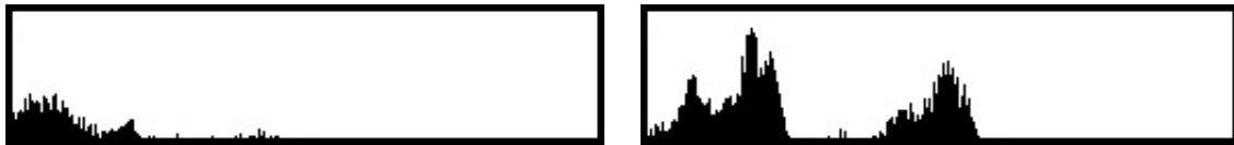
Figura 6.18: Exemplo de histogramas. (a) Histograma da região do objeto da Figura 6.17. (b) histograma da vizinhança do objeto da Figura 6.17.
