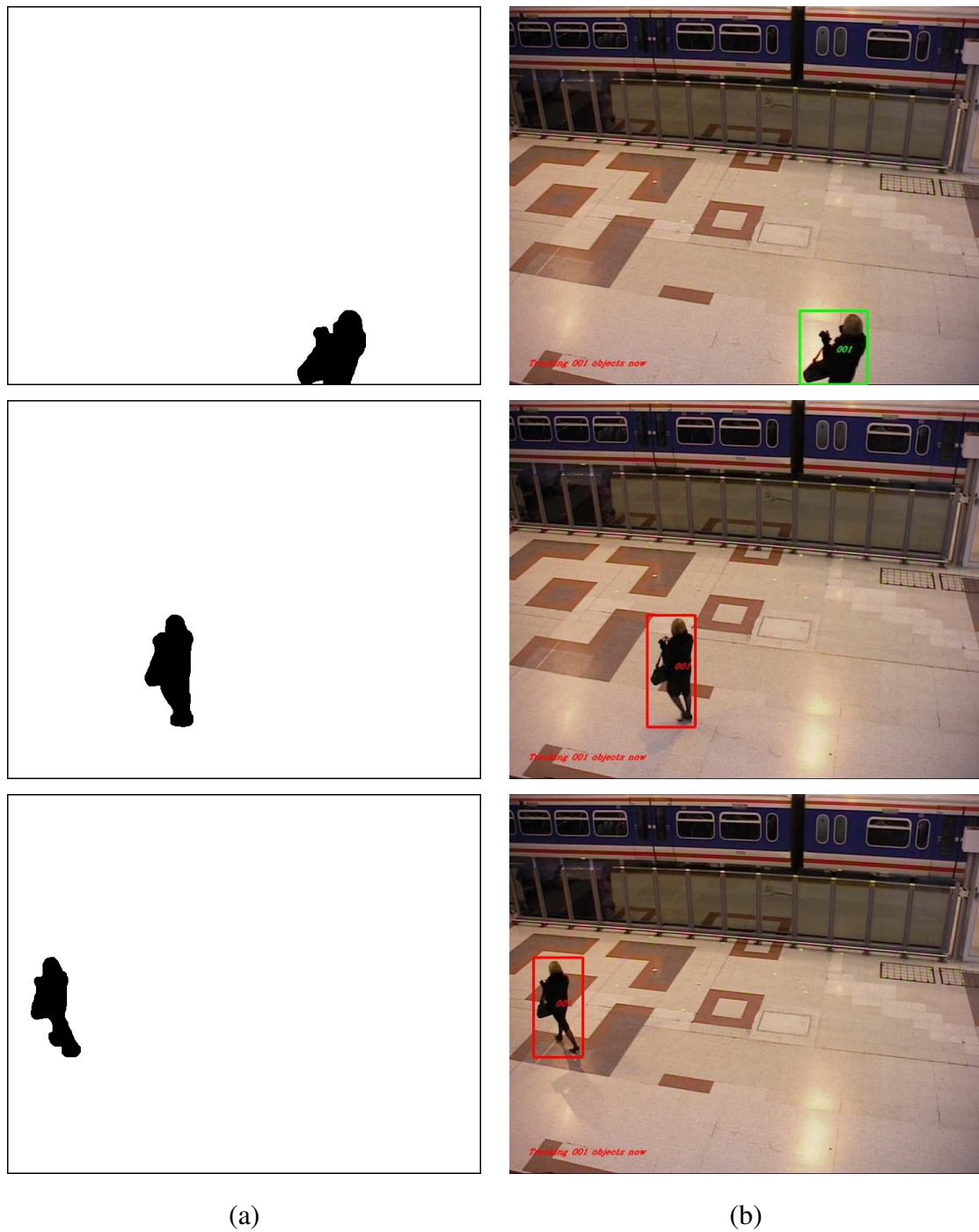
Figura 6.8: Resultados obtidos pelo Algoritmo 1 para o Objeto 1. (a) Saída do módulo detector de movimento. (b) Objeto 1 rastreado, em estado Novo (verde) e Rastreando (vermelho).
