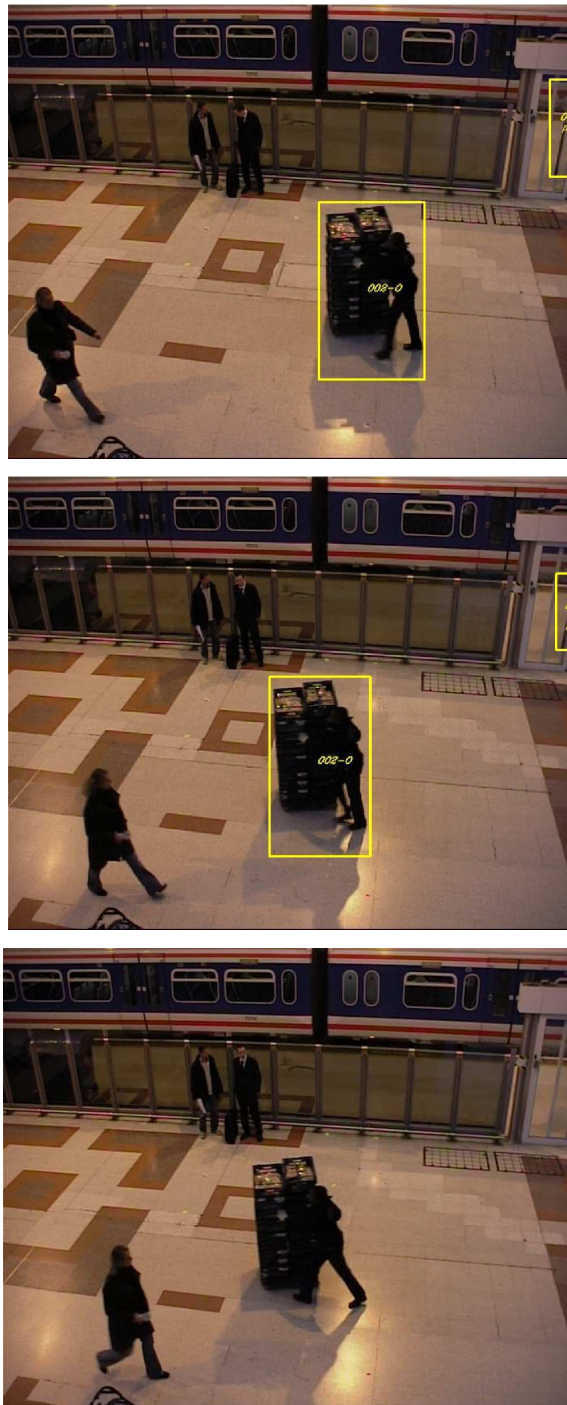
Figura 6.23: Exemplos de falsos alarmes gerados para o Vídeo 2. Os objetos envolvidos no alarme são destacados por um retângulo amarelo. A letra O indica o dono do objeto. A letra A indica o tipo de ação primitiva: abandono ( A ) ou remoção ( R ).
