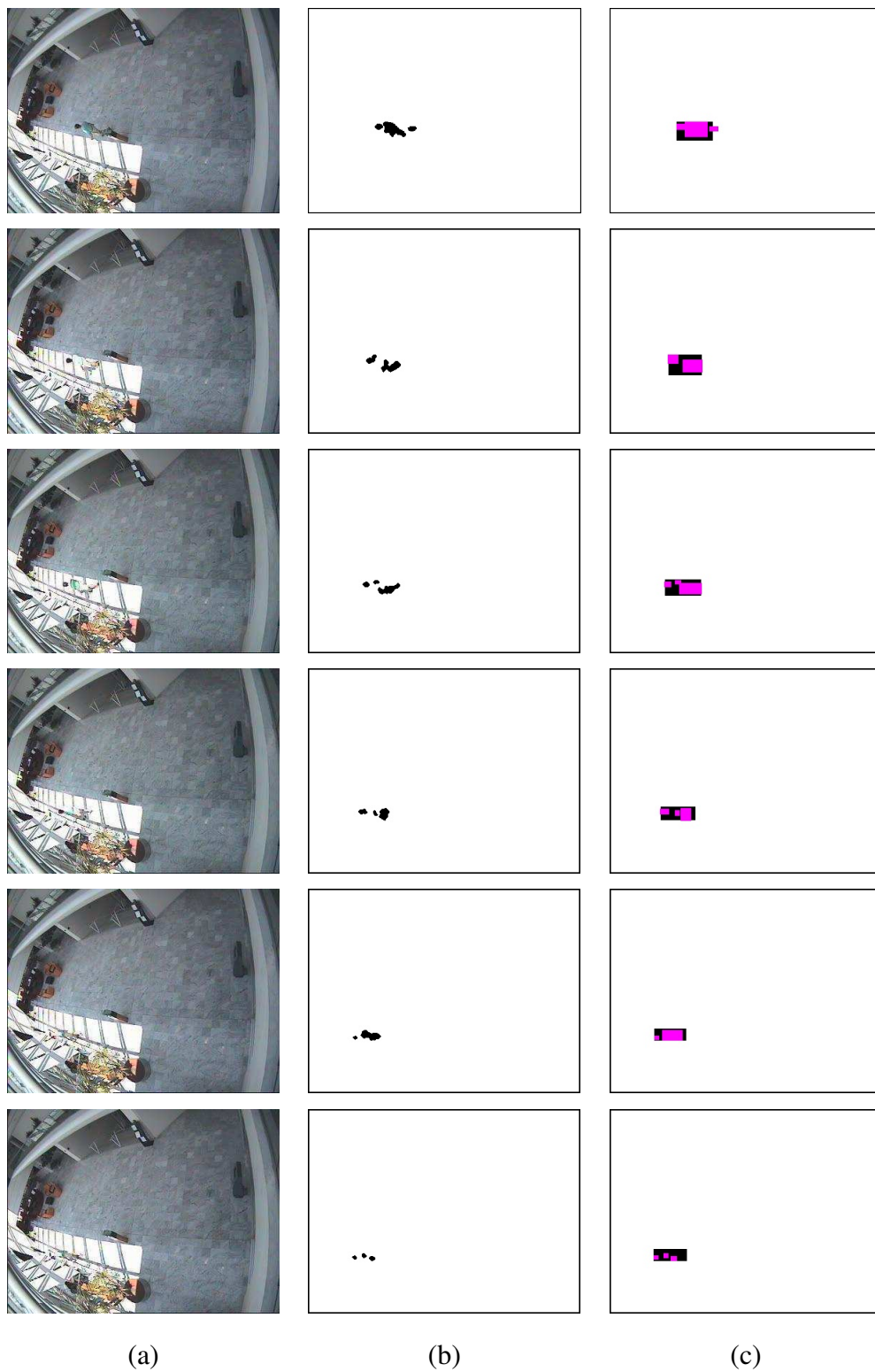
Figura 6.2: Exemplos de segmentação fragmentada pelo modelo W4 . (a) Imagem de entrada. (b) Imagem segmentada. (c) Comparativo entre conjunto verdade (cor preta) e objetos segmentados (cor vermelha).
