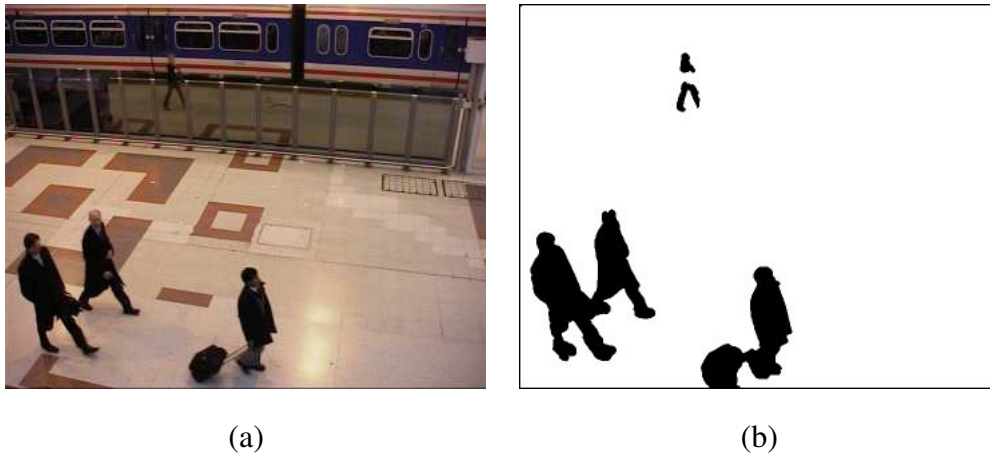
Figura 2.1: Exemplo de segmentação de movimento. (a) Quadro do vídeo original utilizado como referência para segmentação do movimento. (b) Quadro resultante do processo de segmentação.
