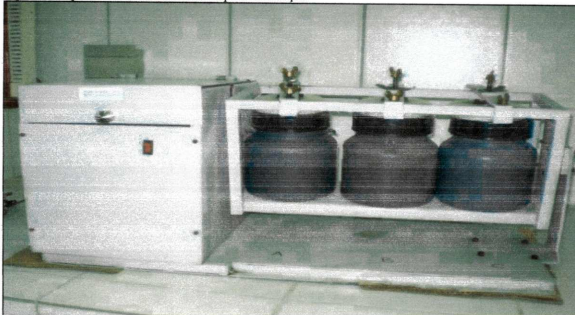
Figura 15. Aparelho Rotativo de Frascos para Lixiviação
