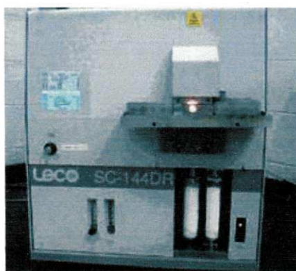
Figura 21 - Equipamento LECO SC 132 utilizado para análise de enxofre.
