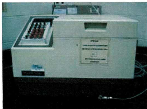
Figura 22: Calorímetro Parr 1261 análise do poder calorífico das amostras.
