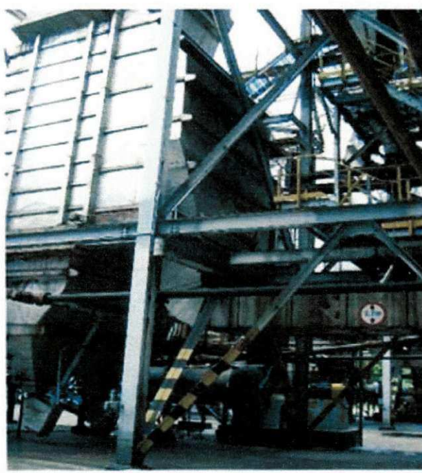
Figura 16: Ponto de retirada dos finos de carvão do ciclone, Refinaria da ALUMA.
