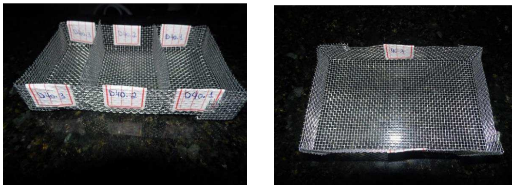
Figura 3.30: Cestos desenvolvidos para cinética de secagem e o acompanhamento do encolhimento.
