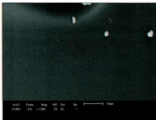
As membranas de PES obtidas com 3% de argila, figura 20, apresentaram uma superfície aparentemente densa, com uma melhor dispersão da argila em relação as membranas anteriormente apresentadas, o que corrobora com o resultado de DRX apresentado na figura 15. Há também pequenos aglomerados na superfície da membrana.
