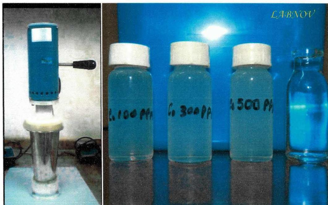
FIGURA 11 – Agitador utilizado para preparação das emulsões e ilustrações das emulsões de 100, 300 e 500 ppm, comparadas a água pura.
