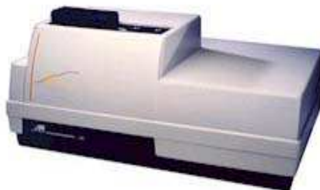
Figura 3.2: Aparelho analisador de tamanho de partículas por difração a laser – granulômetro - modelo 1064 LD da Cilas.
