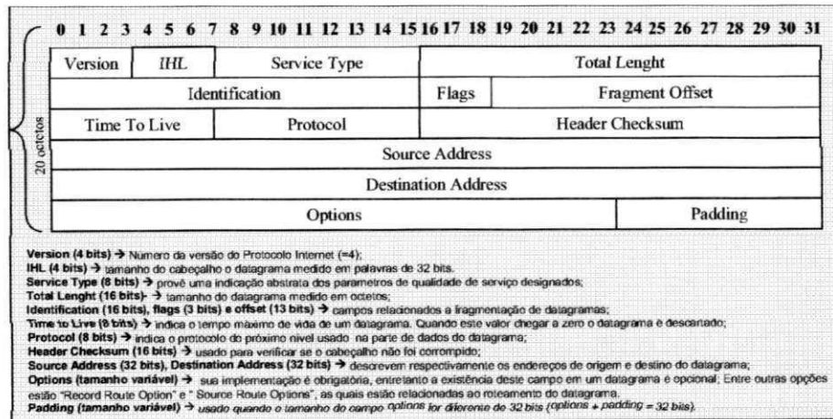
Figura 3.1: Cabeçalho do datagrama IPv4 [Comer, 95].
