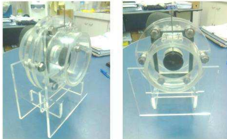
Figura 23: Célula experimental para medição do Número de MacMullin (NMac).
