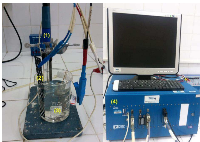
Figura 26: Montagem experimental para a preparação dos eletrodos de Ag/AgCl.
