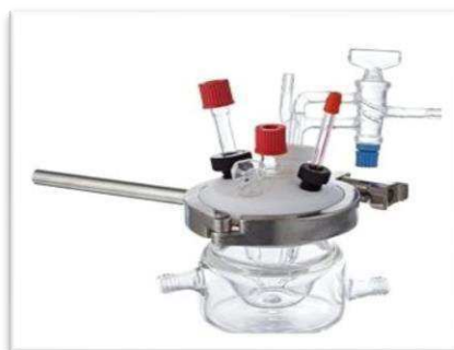
Figura 13– Célula eletroquímica de três eletrodos.
