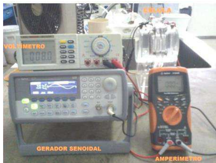
Figura 24: Sistema experimental para medição do Número de MacMullin (NMac)
