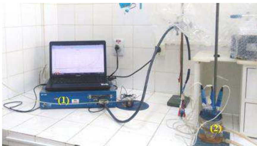
Figura 25: Montagem experimental (ensaios de voltametria cíclica).
