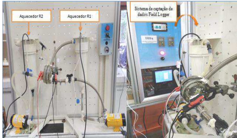
Figura 15: Reator eletroquímico com controlador de temperatura.
