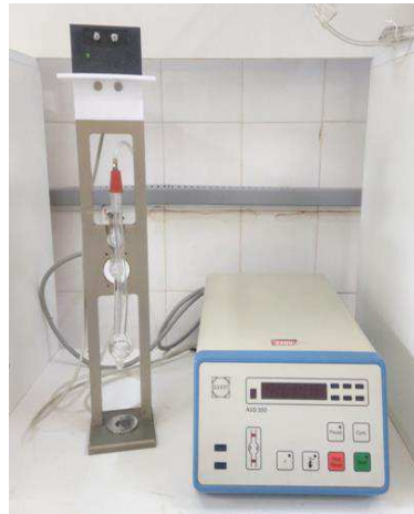
Figura 29: Viscosímetro de Cannon Fenske AVS 380.
