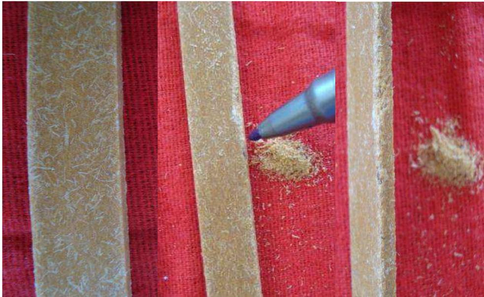
**Figura 4.25** – Ampliação do aspecto visual dos compósitos híbridos PP/sisal/organofílica contendo 5% em massa de argila (PP/HB5) envelhecidos por 15 dias.
