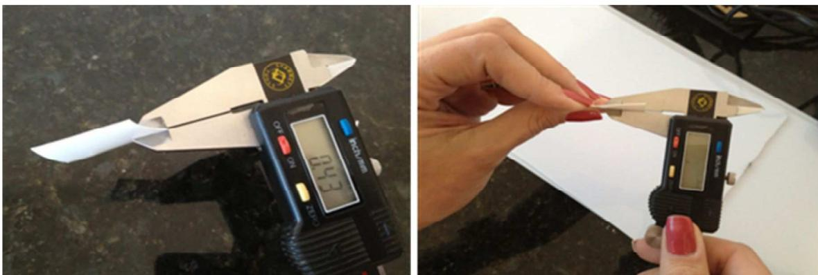
Para as medições das espessuras, foram realizados cortes das embalagens nas direções longitudinal e transversal, sendo medidas as espessuras da região plana. Desta forma, foi traçado um perfil de espessuras ao longo da embalagem, considerando as regiões mais importantes de análise. Os valores de espessura total foram obtidos pela média aritmética entre 5 amostras.
