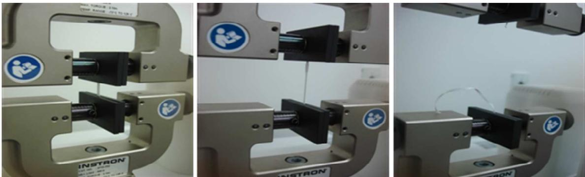
O teste foi realizado em duplicata, em amostras retangulares com dimensões de 25mm x 75mm, a uma velocidade de 100 mm/min. A partir de seus resultados
