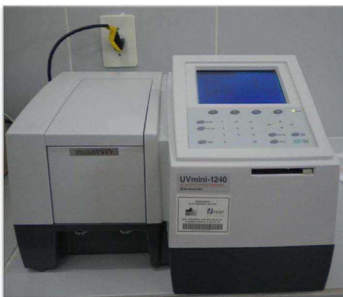
Figura 4.39 - Espectrofotômetro mini (UV-Vis) Shimadzu modelo 1240.
