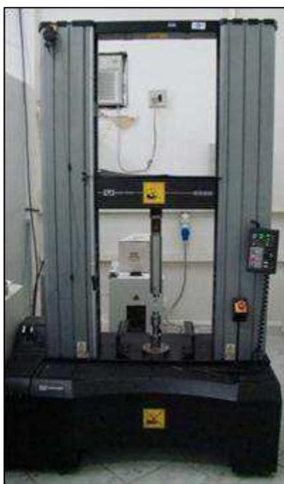
Figura 4.27 - Máquina Universal de Testes.
