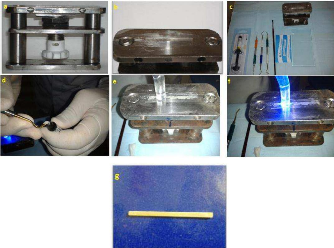
Figura 4.20 - (a) Molde metálico usado para obter as amostras para o teste de flexão três pontos; (b) cavidade do molde para preparação dos corpos de prova e (c) corpo de prova para ensaio de flexão.
