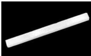
Figura 4.25 - Corpo de prova em forma de 7 mm x 1 mm x 1 mm.
