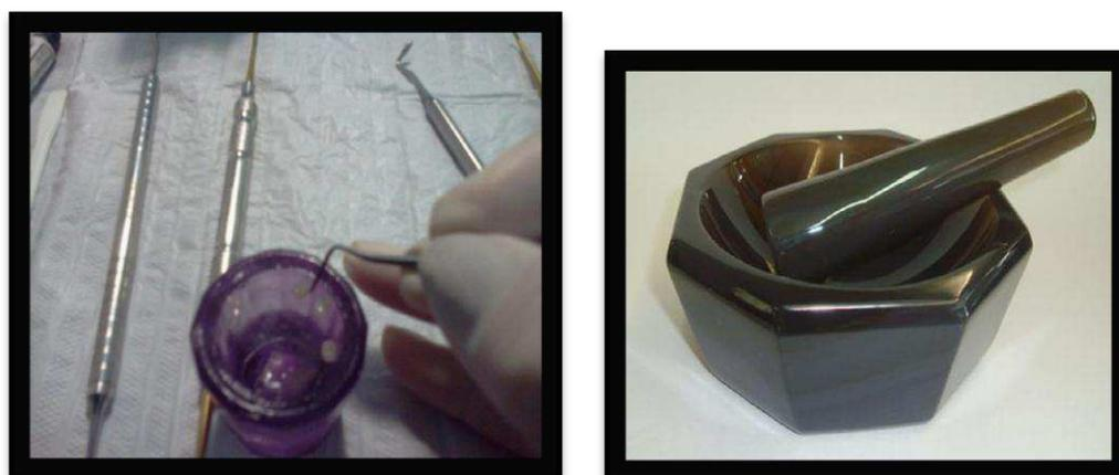
Figura 4.11 - (a) Resina Z100 (384,50 mg) adicionada a dispersão argila/diluente e (b) o gral e pistilo de ágata empregado para mistura dos componentes resina/argila/diluente.
