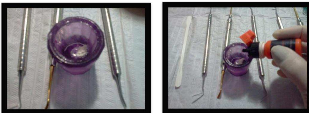
Figura 4.10 - (a) Argila Cloisite 20A (6,50 mg) e (b) adição do diluente Adper Single Bond(3M/ESPE) (0,25 mL) à argila.
