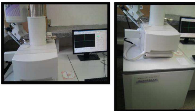
Figura 4.34 - Microscópio Eletrônico de Varredura da marca Shimadzu, modelo SSX-550 Superscan utilizado na caracterização dos nanohíbridos.
