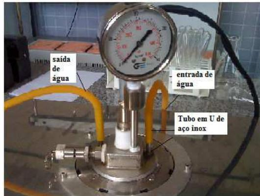
**Figura 16** – Sistema de resfriamento do reator hidrotérmico de micro-ondas utilizado na síntese de materiais nanoestruturados
