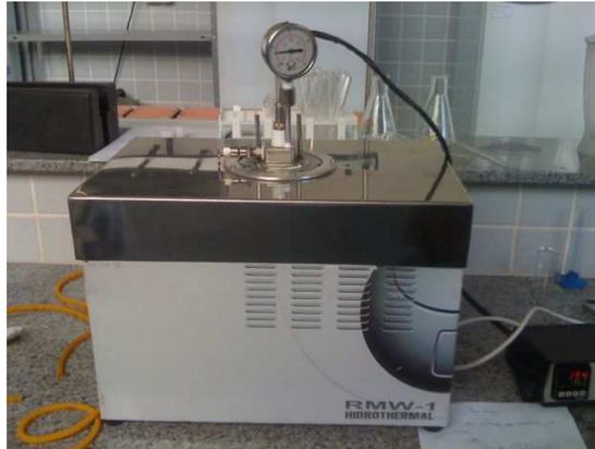
**Figura 13** – Reator hidrotérmico de micro-ondas utilizado para síntese dos materiais.
