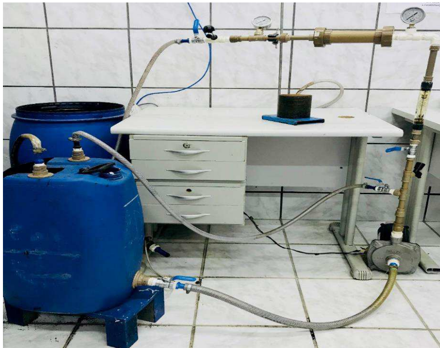
Figura 33 - Sistema de separação óleo/água no sistema membrana cerâmica.
