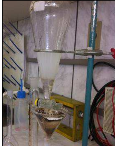
Figura 19 - Indicação do fim da extração pela coloração esbranquiçada nas duas fases (Fonte: LABDES).
