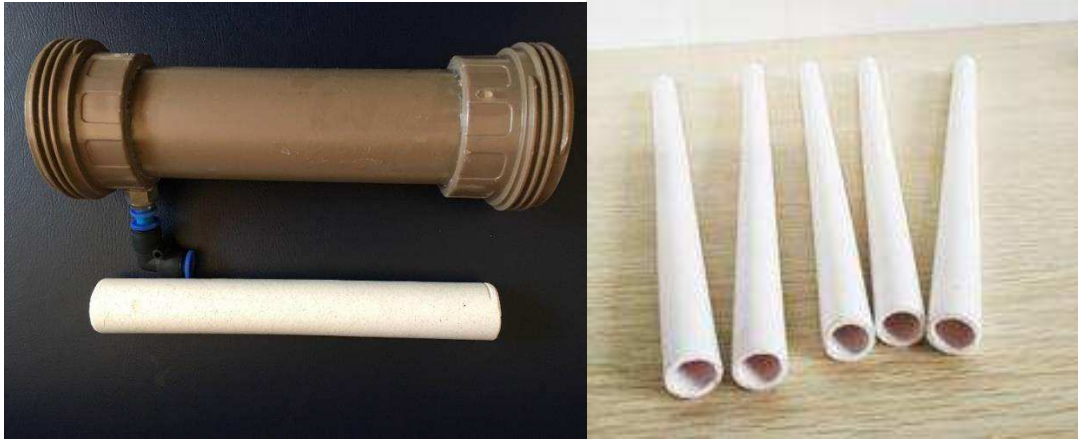
Figura 24 - Membrana cerâmica tubular monocanal e permeador em PVC (Fonte: LABDES, 2014).
