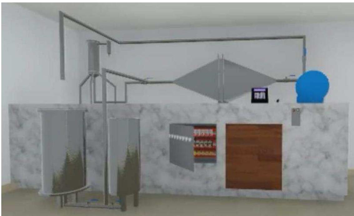
A secagem foi realizada nas temperaturas de 50°C, 60°C e 70 ° C com uma velocidade do ar de 1,2 m/s. Sempre ao ligar o secador esperava-se um determinado tempo até a temperatura estabilizar e atingir o valor desejado. Os cubos da casca foram distribuídos em uma única camada na bandeja e postos no secador com fluxo de ar passando perpendicularmente pela matéria-prima.
