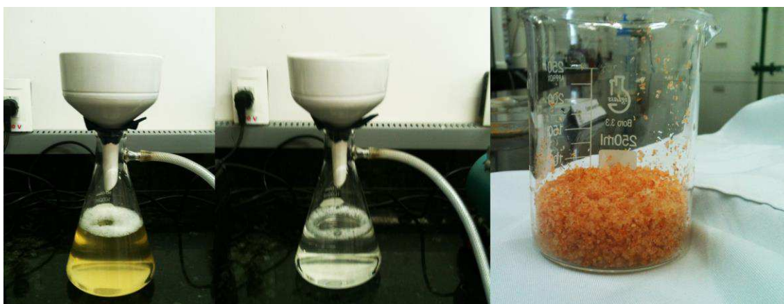
Figura 22 - Casca pós-processo de desmineralização
