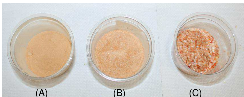
Figura 20 - Amostras de casca em três granulometrias (A) abaixo de 53\mu\text{m} , (B) 53\text{-}150\mu\text{m} e (C) acima de 150\mu\text{m}
