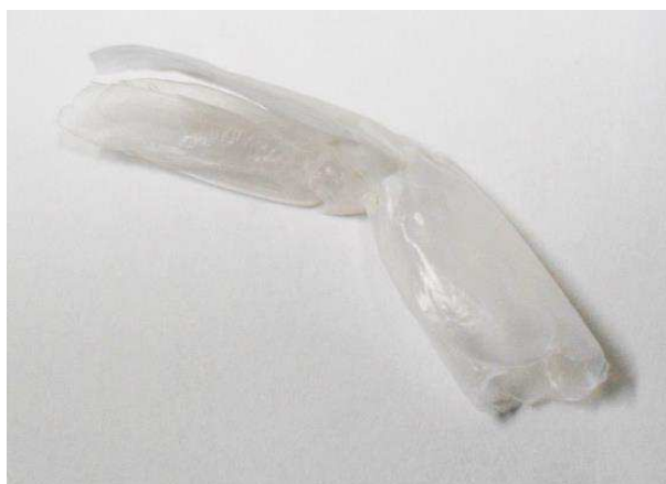
Figura 25 - Amostra do exoesqueleto de camarão após desproteínização
