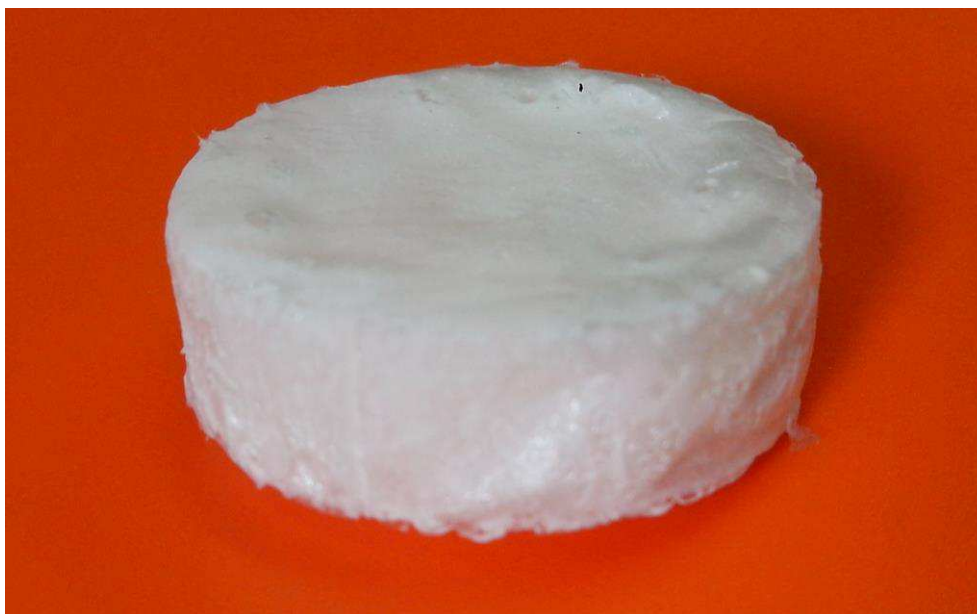
Figura 47 -. Scaffold produzido com quitosana de baixo peso molecular
