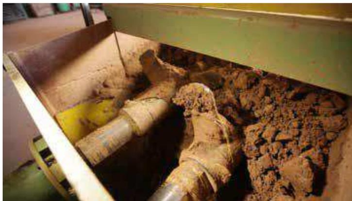
Figura 2.11 - Processo de mistura da massa cerâmica.
