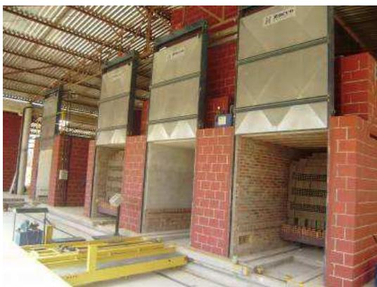
Figura 2.19 - Secador contínuo tipo túnel. Fonte:
