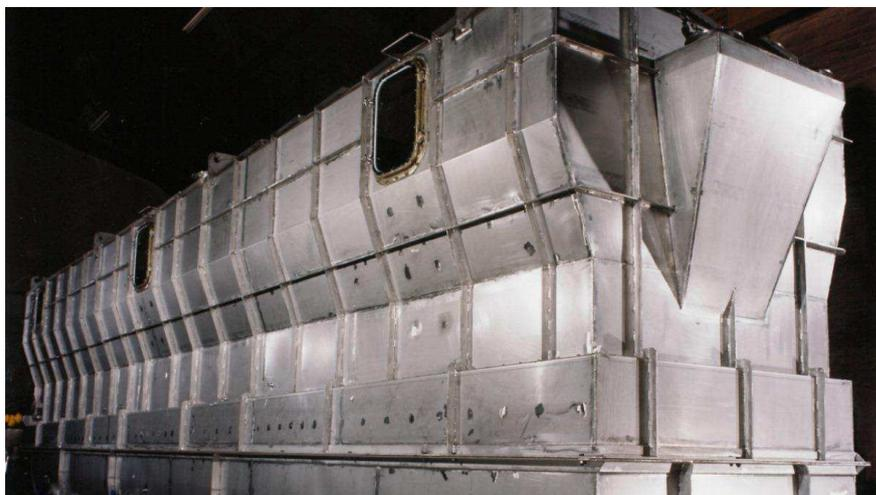
Figura 2.16 - Secador de leito de fluido (estático). Fonte:
