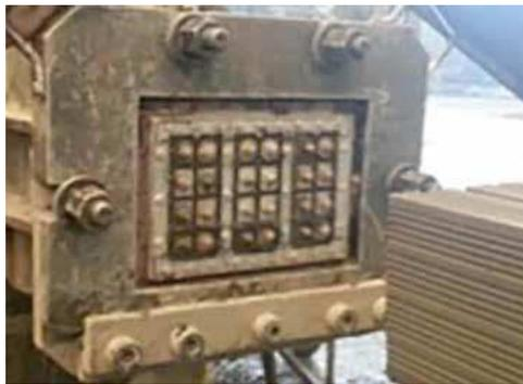
Figura 2.13 – Vista de um bocal para fabricação de blocos. Fonte: FIEMG (2013)
