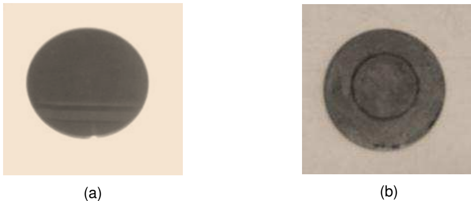
Figura 4-2 – Amostra do aço API 5L X65 utilizado nos ensaios eletroquímicos: (a) Amostra antes do processo de permeação; (b) Amostra após o processo de permeação.
