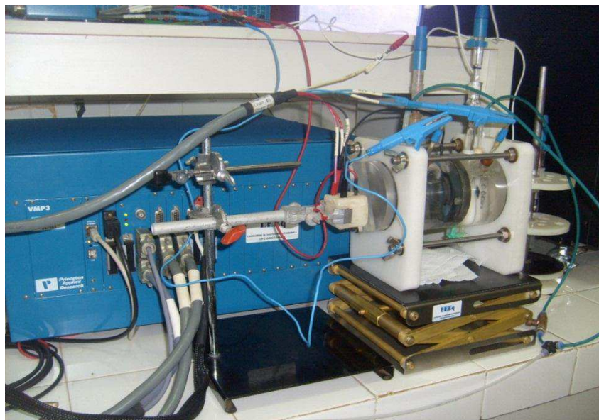
Figura 4-3 – Célula de permeação eletroquímica conectada ao potenciostato VMP3 (Projeto RPCMODE, ARAÚJO 2009).
