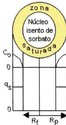
Figura 3.1 – Diagrama esquemático indicando os perfis de concentração para a adsorção através de pellets (ou aglomerado de partículas) sobre condições de controle difusional no macroporo (RUTHVEN, 1984)
