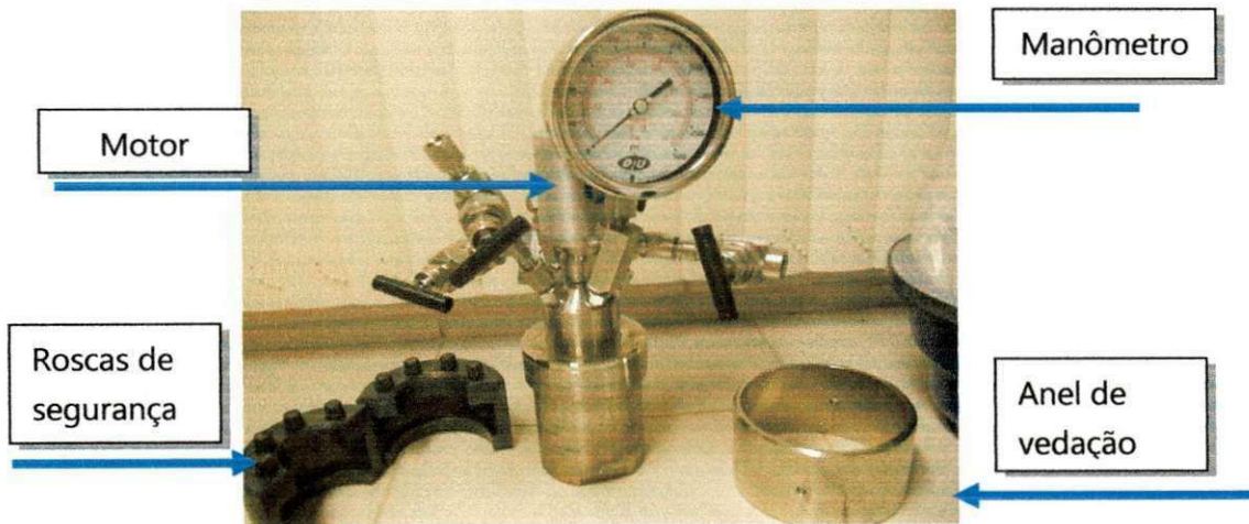
Figura 3.3 Componentes do reator.
