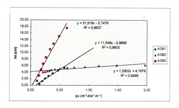
Figura 12- Relação entre cargas hidráulicas de entrada (h<sub>e</sub>) e a descarga unitária de fluxo (q<sub>u</sub>) para os sistemas drenantes A<sub>3</sub>B<sub>1</sub>, A<sub>3</sub>B<sub>2</sub> e A<sub>3</sub>B<sub>3</sub>.
