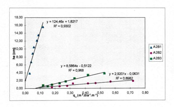
Figura 11- Relação entre cargas hidráulicas de entrada (h<sub>e</sub>) e a descarga unitária de fluxo (q<sub>u</sub>) para os sistemas drenantes A<sub>2</sub>B<sub>1</sub>, A<sub>2</sub>B<sub>2</sub> e A<sub>2</sub>B<sub>3</sub>.
