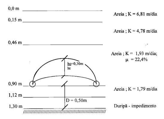
Figura 8 - Modelo de fluxo do aqüífero para regime não-permanente
