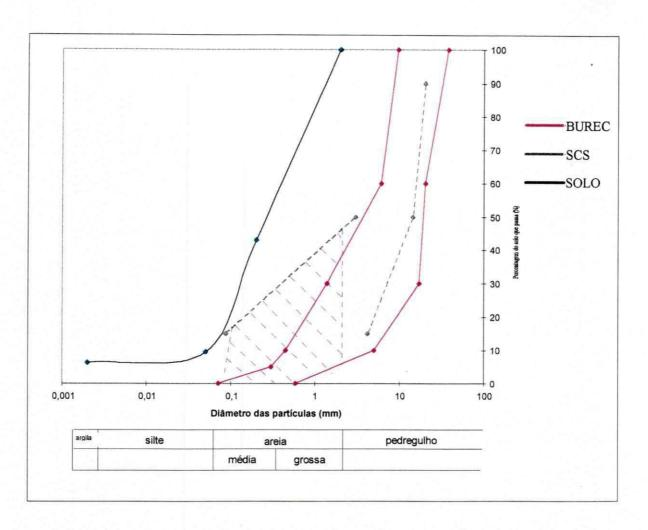
Figura 9 - Curva granulométrica dos filtros, segundo os critérios do SCS e BUREC
