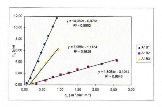
Figura 10 - Relação entre cargas hidráulicas de entrada ( $h_e$ ) e a descarga unitária de fluxo ( $q_u$ ) para os sistemas drenantes  $A_1B_1$ ;  $A_1B_2$  e  $A_1B_3$
