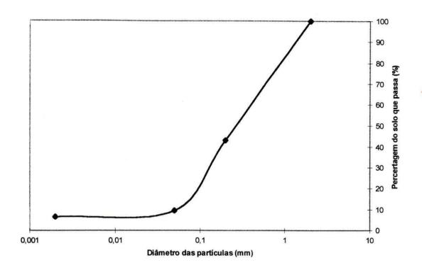
Figura 5 - Curva granulométrica do solo utilizado no modelo físico, referente ao horizonte  $\mathbf{E}_2$
